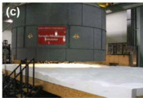
第3-1図 風洞実験の様子(Karstens 2012) (1)
