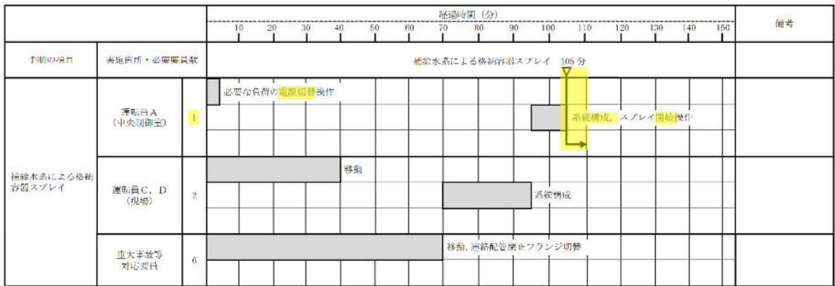
第 1.6-18 図 補給水系による格納容器スプレイ タイムチャート
