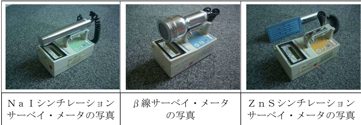
第 4 図 各種サーベイ・メータの写真
