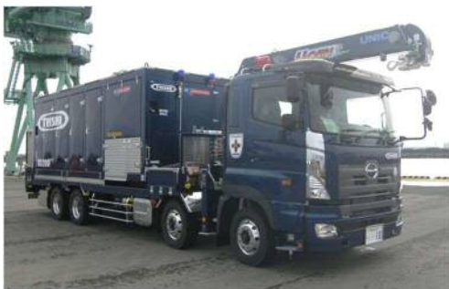
可搬型代替注水大型ポンプ
