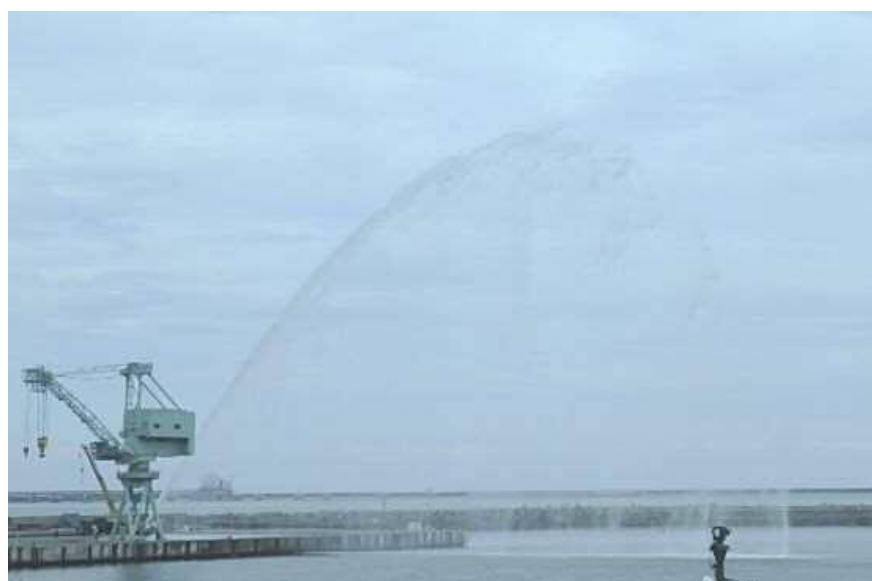
仰角 60° での放水状況（直状放射、ジブクレーン高さ：約 30m）
