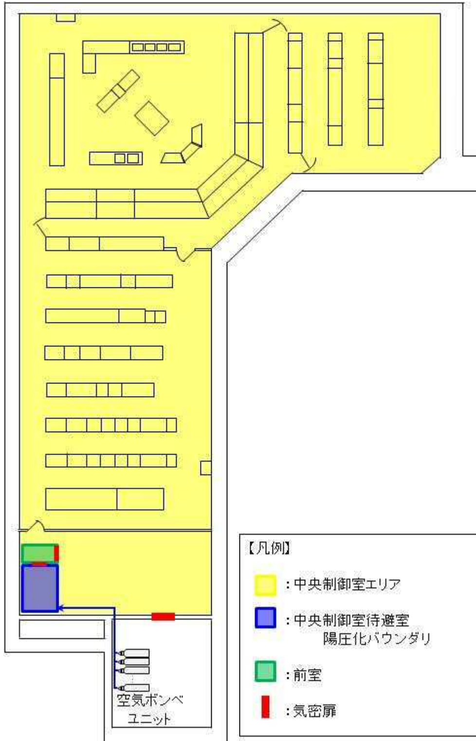
第 1.16-4 図 中央制御室待避室陽圧化バウンダリ構成図
