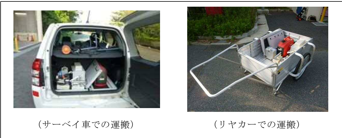
第1図 可搬型モニタリング・ポストの運搬（例）
