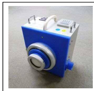
第3図 可搬型ダスト・よう素サンプラの写真
