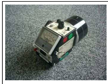
第2図 電離箱サーベイ・メータの写真
