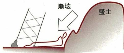
→送電鉄塔近傍に大規模な盛土がある箇所を抽出し、リスク評価する。
