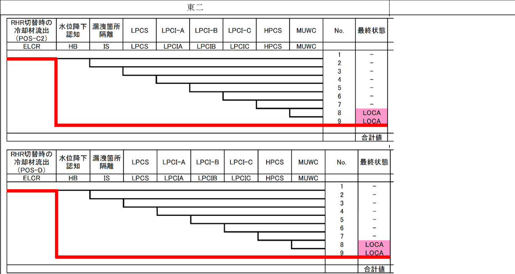
第 3-3 図 「原子炉冷却材流出」における主要なシーケンス (POS-C2, POS-D RHR 切替時の冷却材流出)
