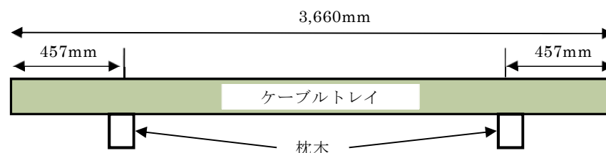
第2図 ケーブルトレイ設置方法
