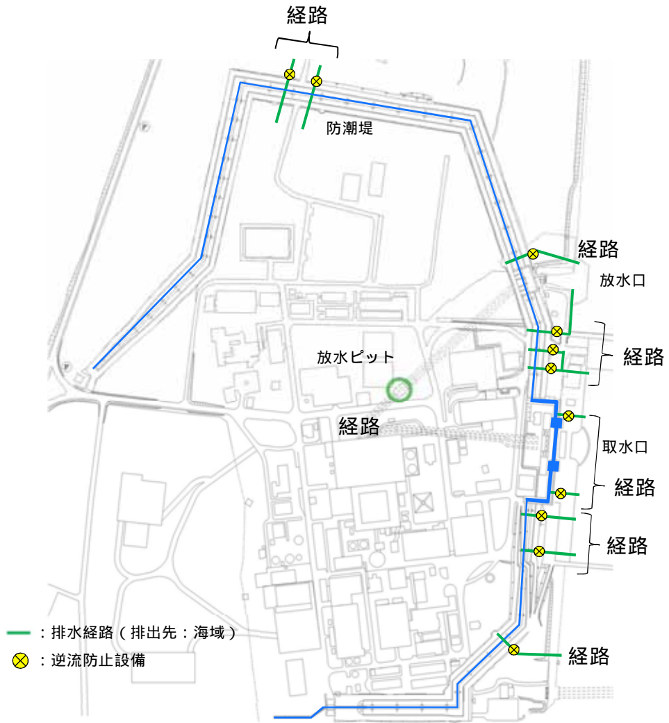
第 2.2-41 図 構内排水路（防潮堤横断部）配置図
