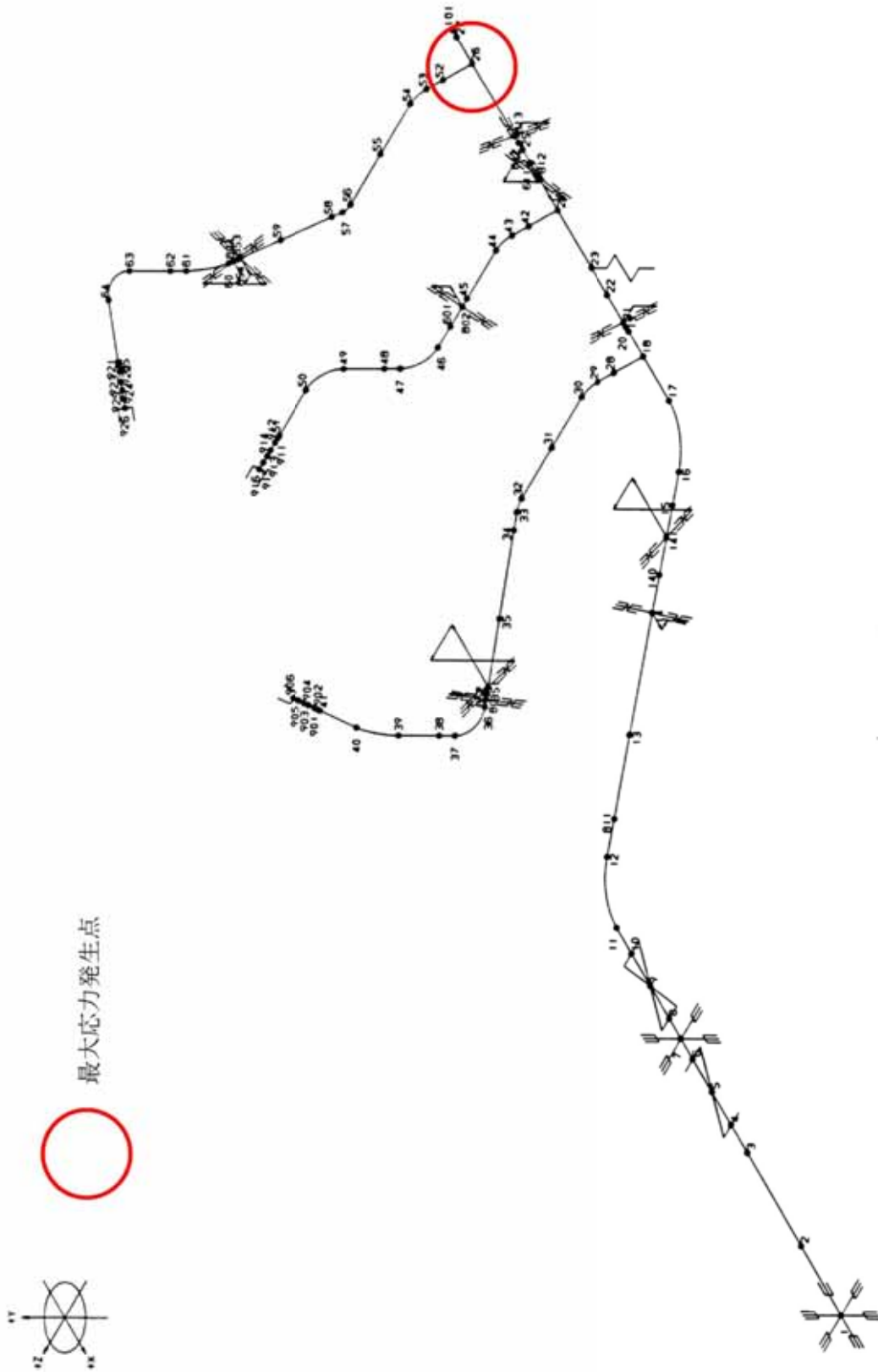
第 6-8 図 給水系配管 (FDW-001 A プラント)
