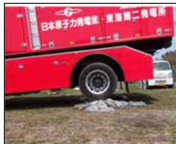
第 1 図 乗越え検証試験状況 ( 2 / 2 )
