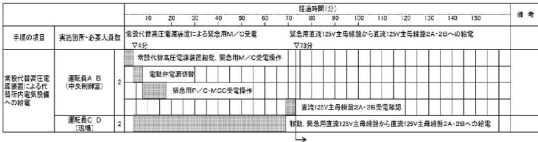
第 3.14.2.2.4-2 図 常設代替高压電源装置による代替所内電気設備への給電タイムチャート\*
