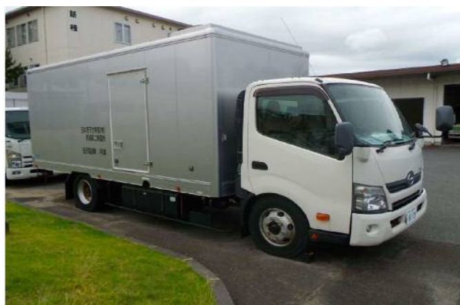
可搬型代替交流電源設備
