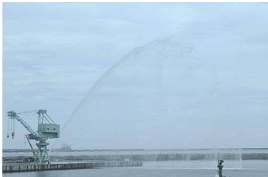
仰角 60^{\circ} での放水状況（直状放射、ジブクレーン高さ：約 30m）
