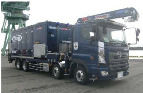
可搬型代替注水大型ポンプ
