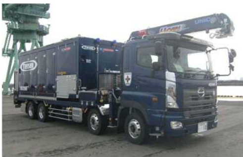
可搬型代替注水大型ポンプ
