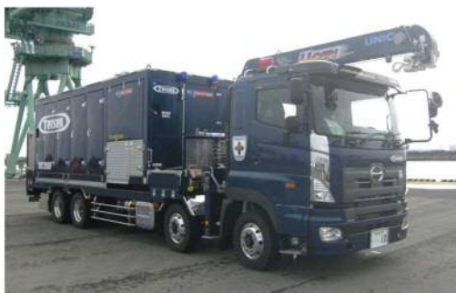
可搬型代替注水大型ポンプ
