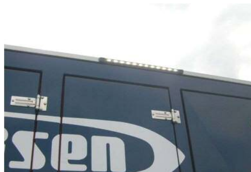
車両の作業用照明拡大
