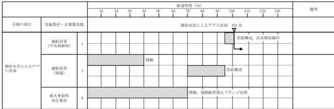
第1.8-12図 補給水系によるデブリ冷却 タイムチャート
