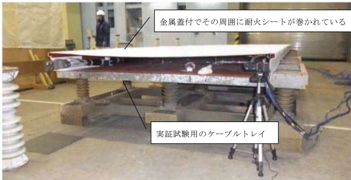
第3図 実証試験用のケーブルトレイ
