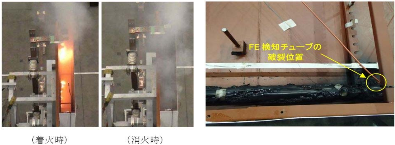
第 9 図 試験 H2 発火・消火・試験後の状態
