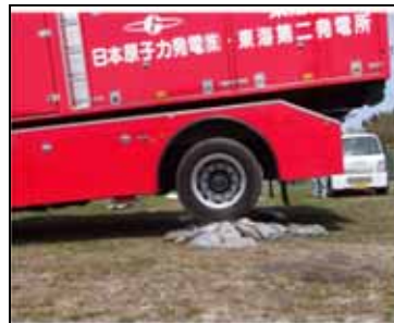
第1図 乗越え検証試験状況(2/2)
