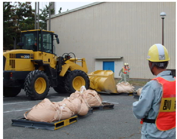
第4図 がれき撤去検証の写真
