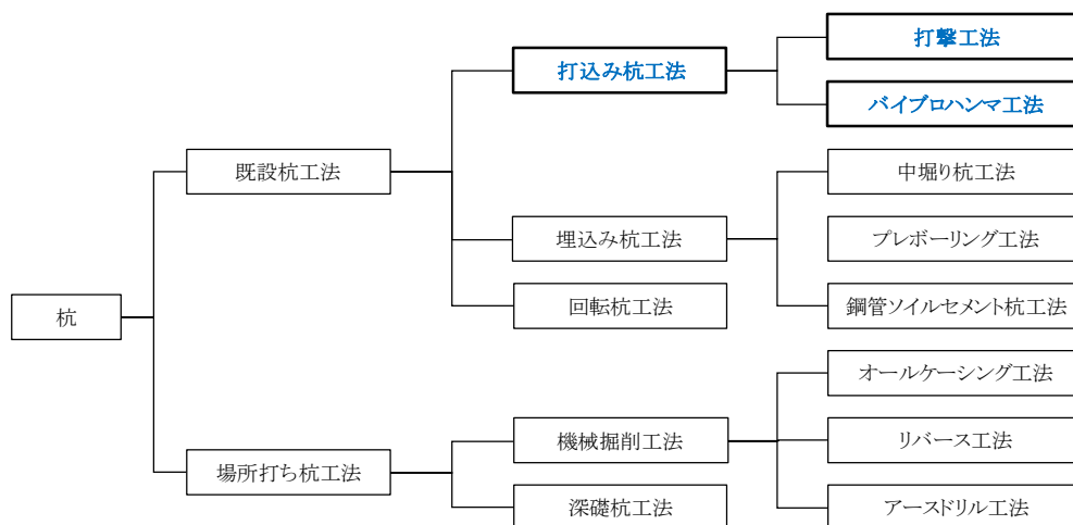
図 3 6 杭の施工方法の分類
