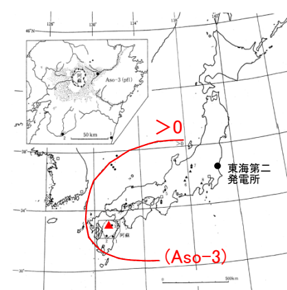
図 2.1-15 阿蘇 3 テフラ (Aso-3) と阿蘇 3 テフラ (Aso-3') の分布と主な産出地点。 ● Aso-3、▲ Aso-3'、点線内は火砕流堆積物 (Aso-3 (pf)) の分布範囲を示す。左上の図は小野・渡辺 (1983) に加筆。
