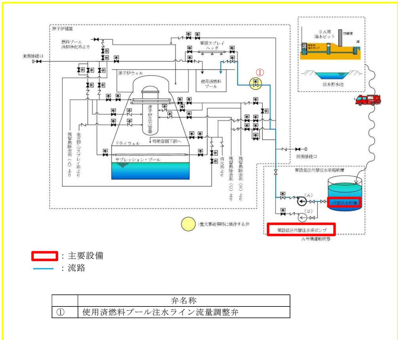
第3.11-1図 代替燃料プール注水系（注水ライン）系統概要図
