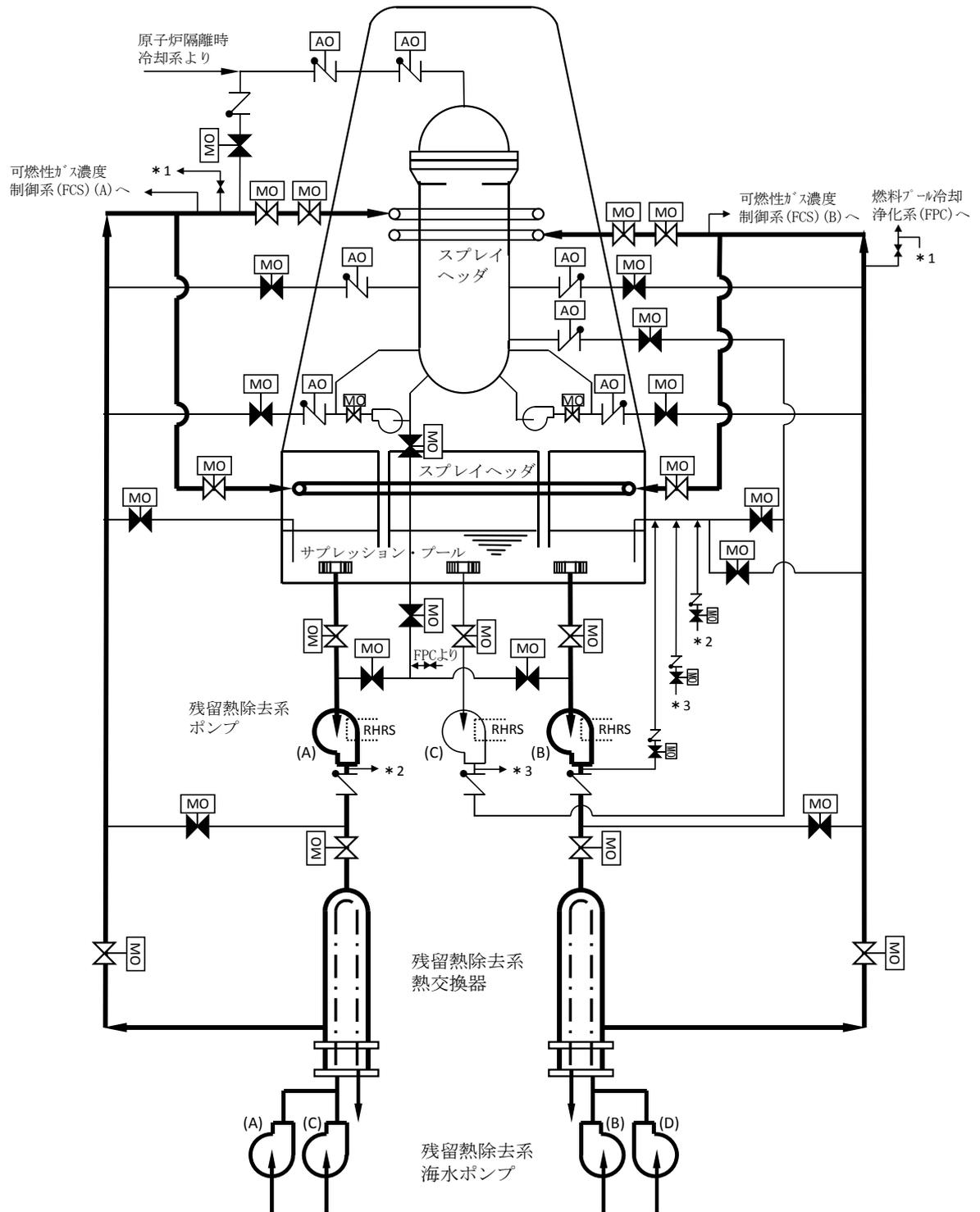
第 9.6-4 図 残留熱除去系（格納容器スプレイ冷却系）
