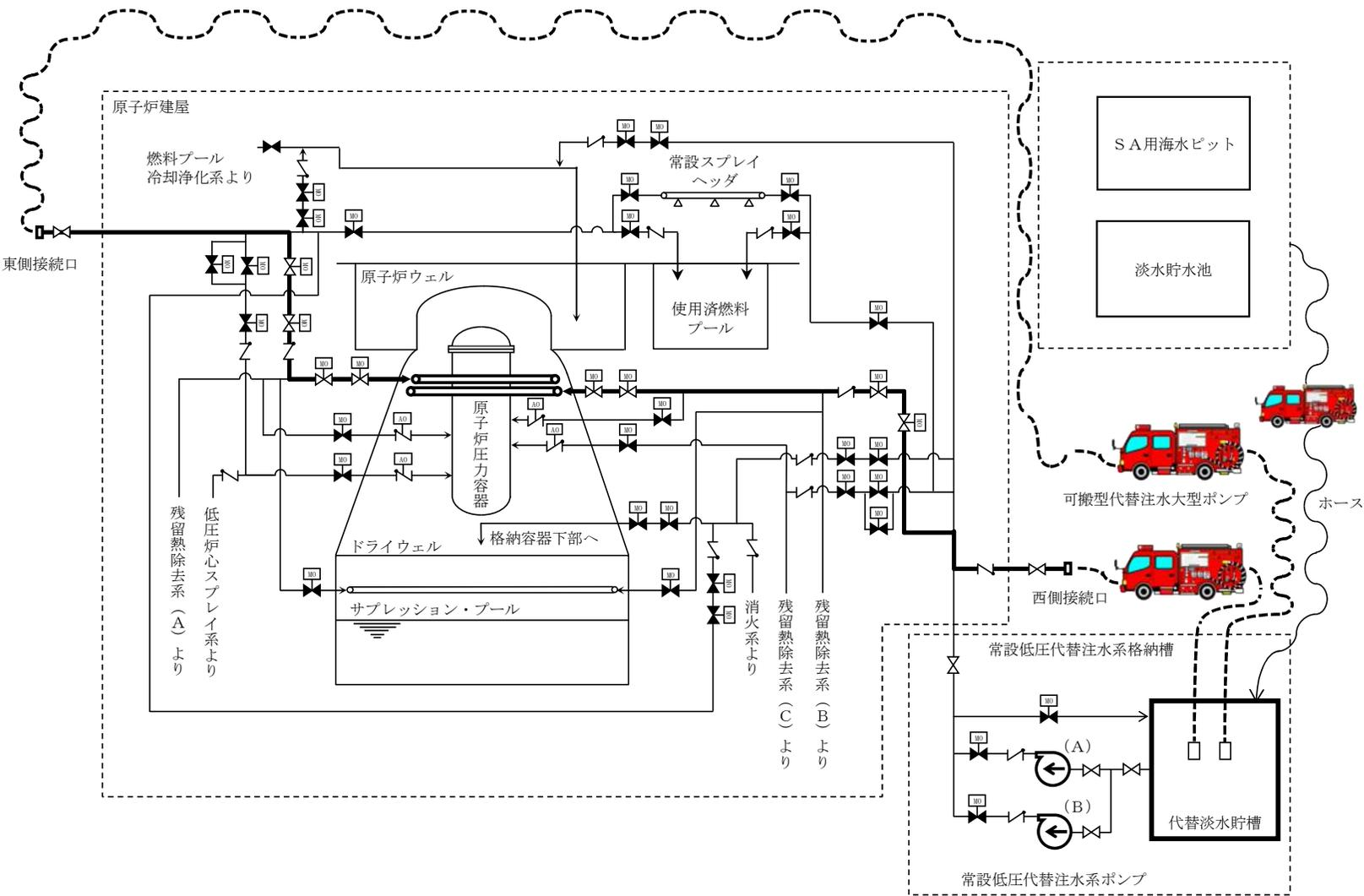
第9.6-2図 代替格納容器スプレイ系（可搬型）による格納容器内の除熱
