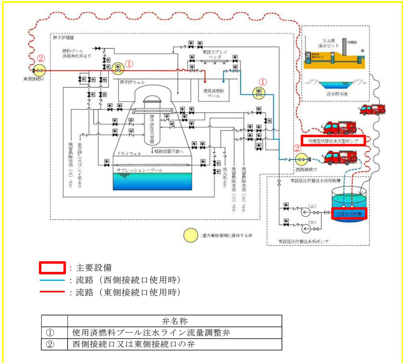
第3.11-2図 代替燃料プール注水系 (注水ライン) 系統概要図
