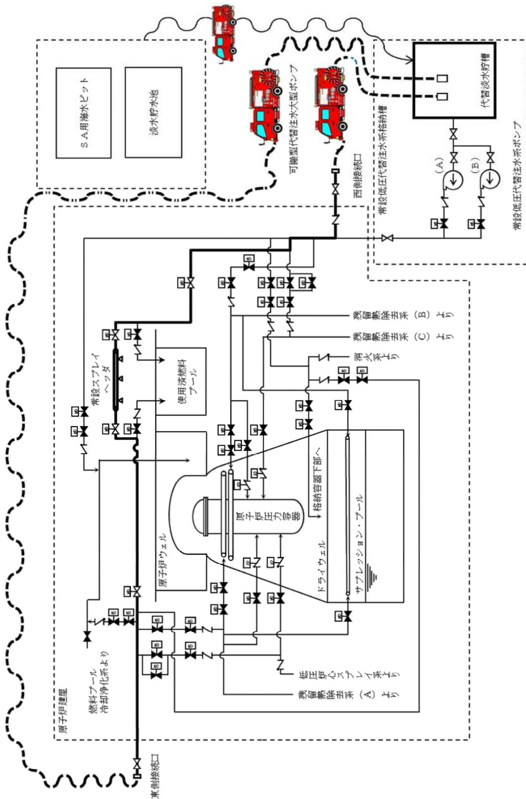
第 4.3-4 図 代替燃料プール注水系（可搬型代替注水大型ポンプ及び常設スプレイヘッドを使用した使用済燃料プール注水及びスプレイ）
