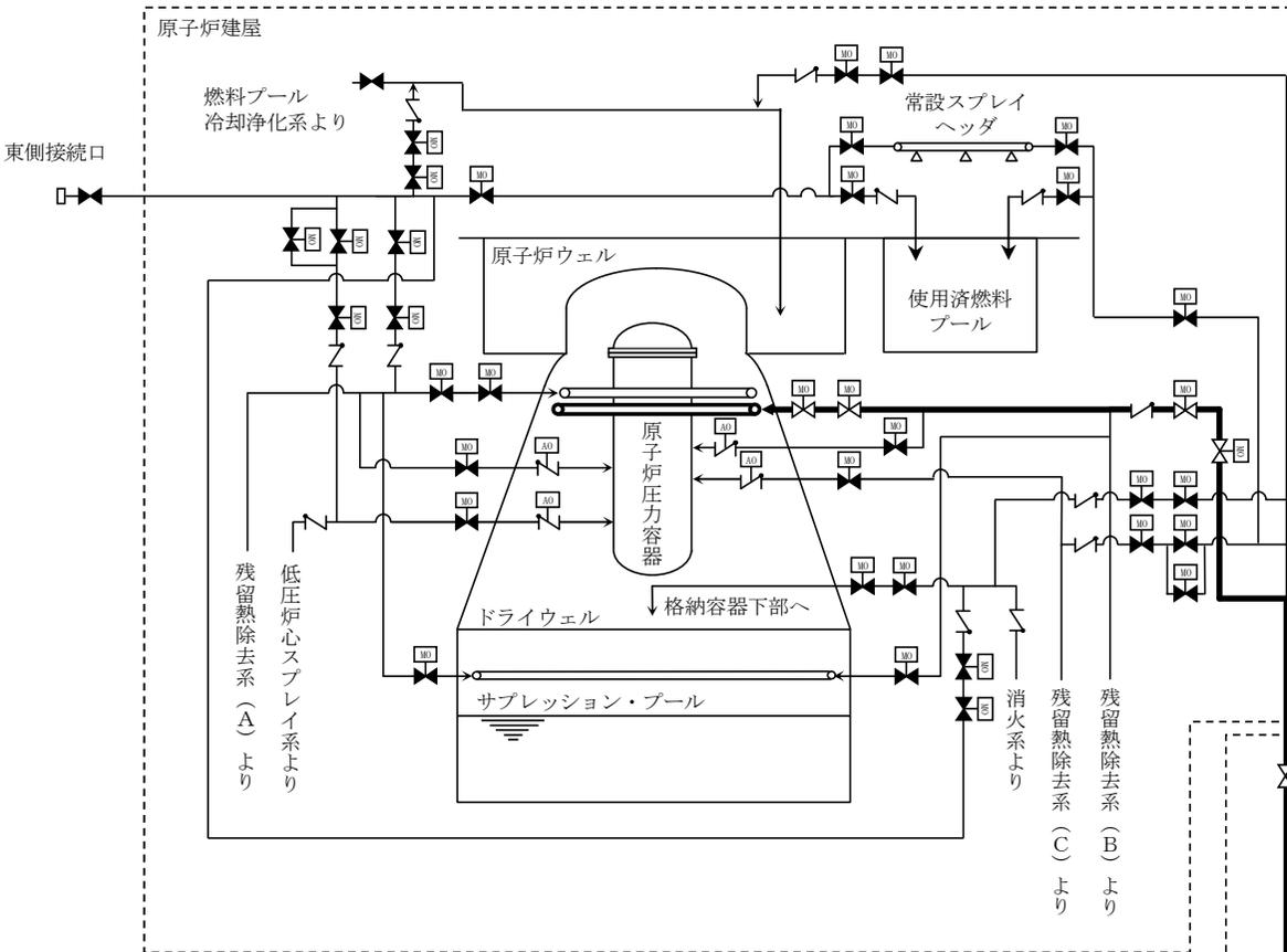
第9.6-1図 代替格納容器スプレイ系（常設）による格納容器内の除熱
