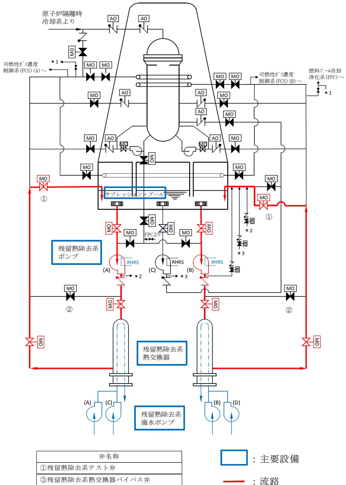
第 3.6-6 図 残留熱除去系 (サブプレッション・プール冷却系)
