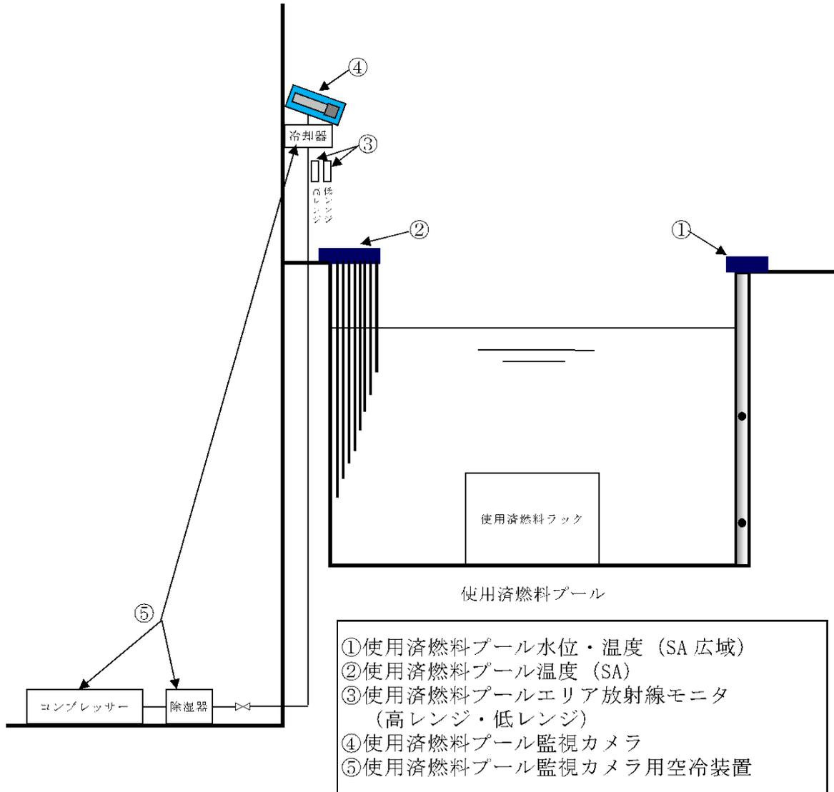
第 4.3-7 図 使用済燃料プール監視設備系統概要図
