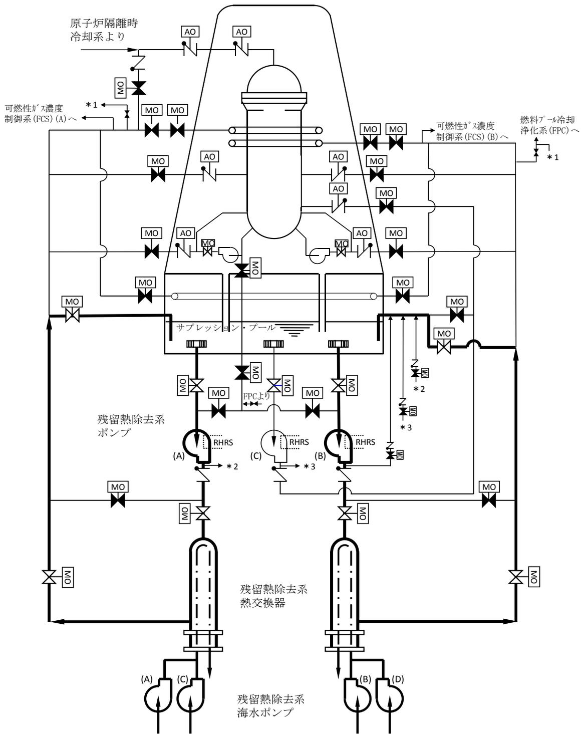
第 9.6-5 図 残留熱除去系（サブプレッション・プール冷却系）
