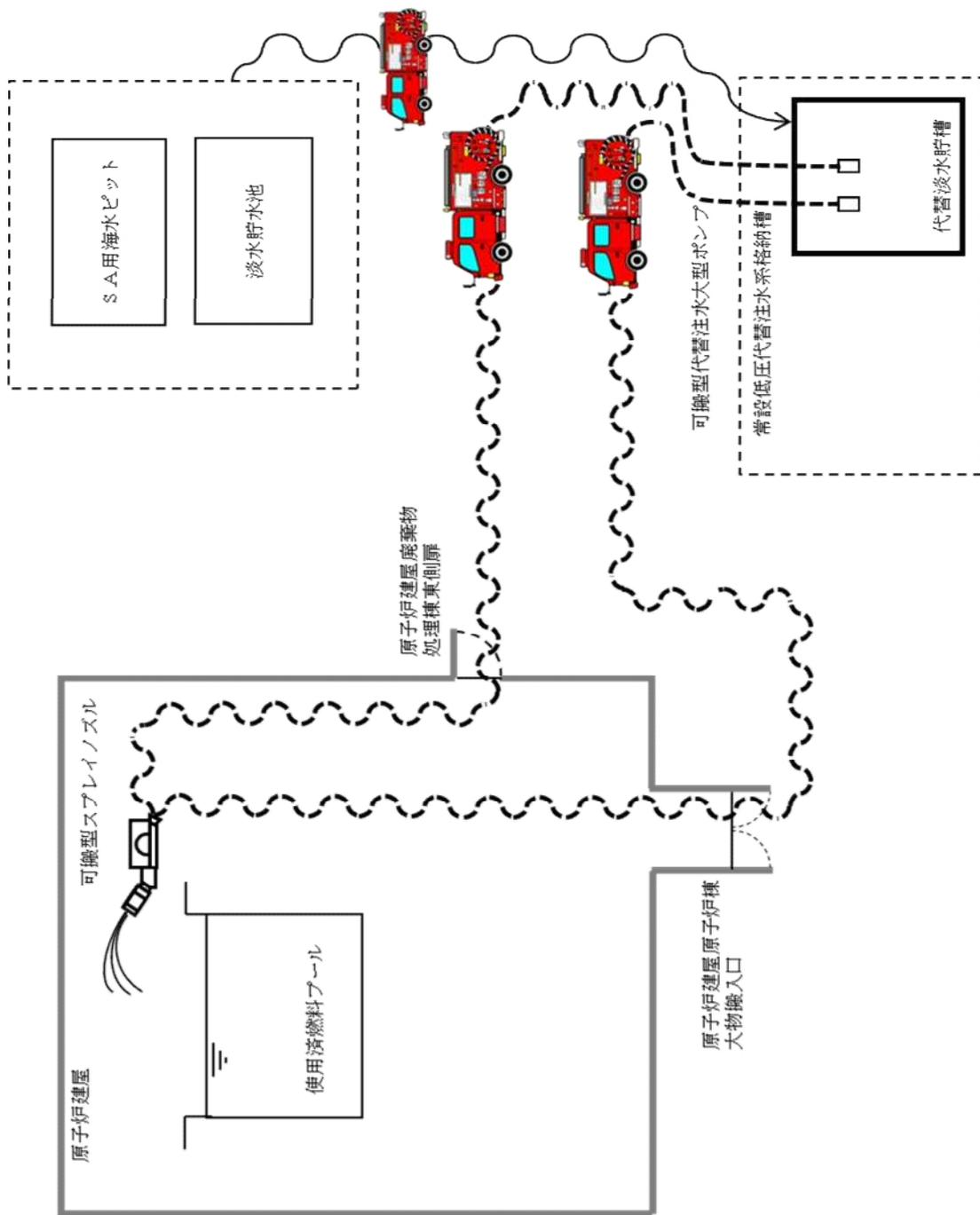
第 4.3-5 図 代替燃料プール注水系（可搬型代替注水大型ポンプ及び可搬型スプレインノズルを使用した使用済燃料プール注水及びスプレイ）系統概要図
