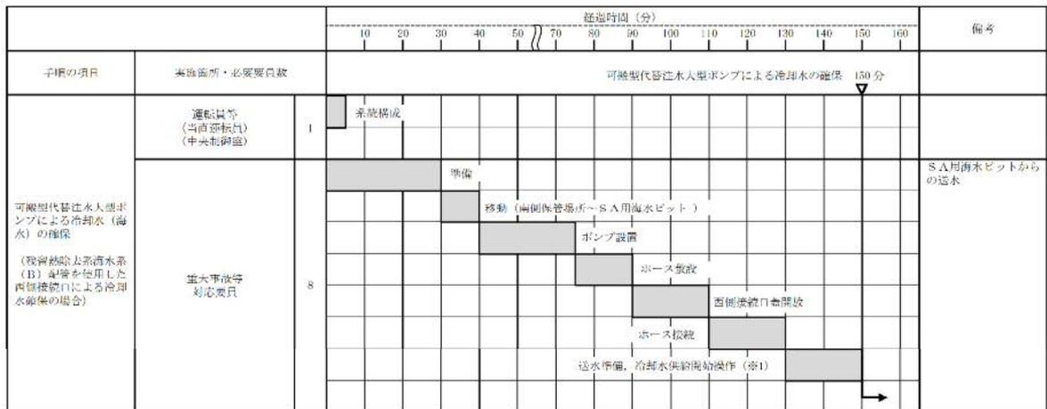
※1：代替燃料プール冷却系東側接続口を使用した送水の場合，可搬型代替注水大型ポンプによる冷却水確保開始まで135分以内と想定する。
