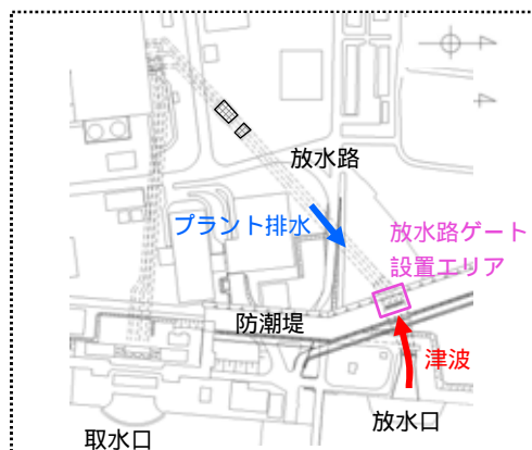
【放水路ゲート設置 エリア】
