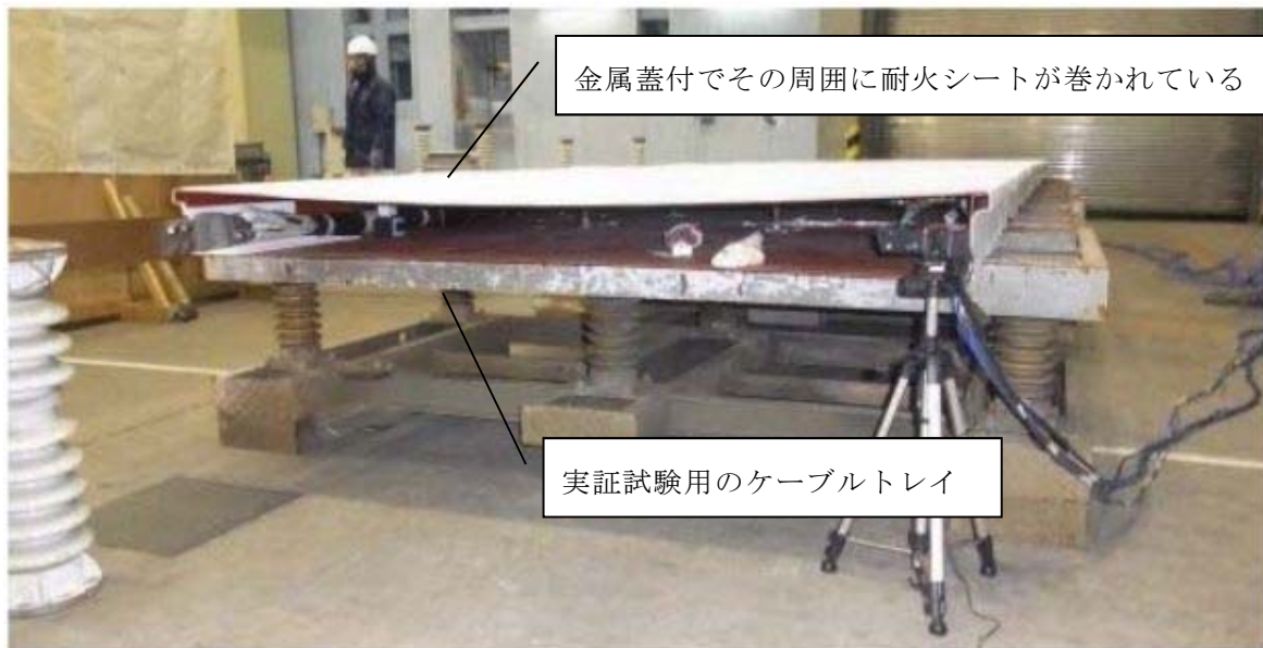
第3図 実証試験用のケーブルトレイ
