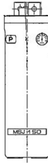
第 57-4-13 図 中性子モニタ用蓄電池 A 系及び B 系外形図
