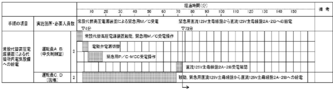
第 3.14.2.2.4-2 図 常設代替高压電源装置による代替所内電気設備への給電タイムチャート*
