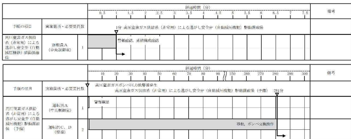
第 3.3-6 図 高圧窒素ガス供給系（非常用）による逃がし安全弁（自動減圧機能）駆動源確保 タイムチャート*
