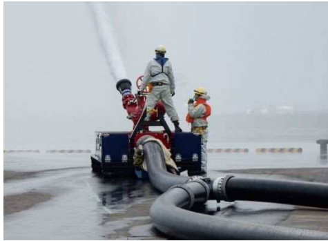
放水砲による放水（直状放射）
