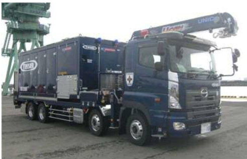
可搬型代替注水大型ポンプ
