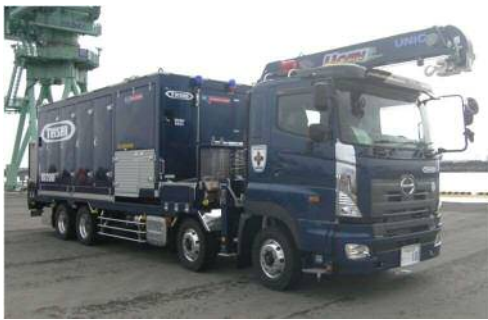
可搬型代替注水大型ポンプ
