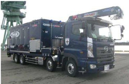
可搬型代替注水大型ポンプ
