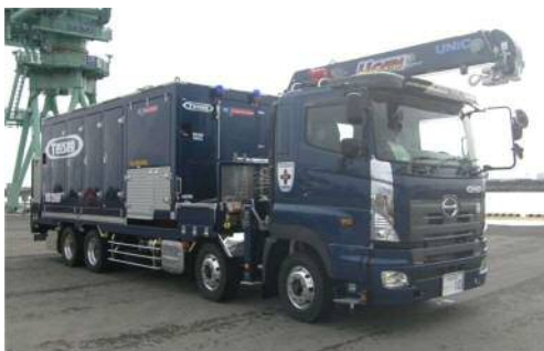
可搬型代替注水大型ポンプ
