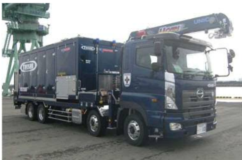
可搬型代替注水大型ポンプ
