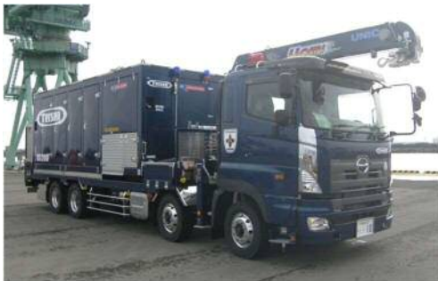
可搬型代替注水大型ポンプ
