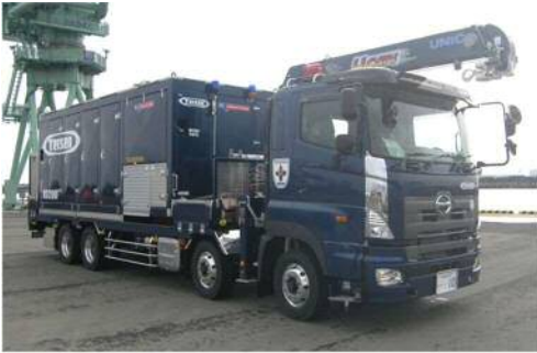
可搬型代替注水大型ポンプ
