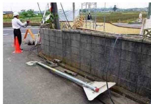
道路標識の折損
