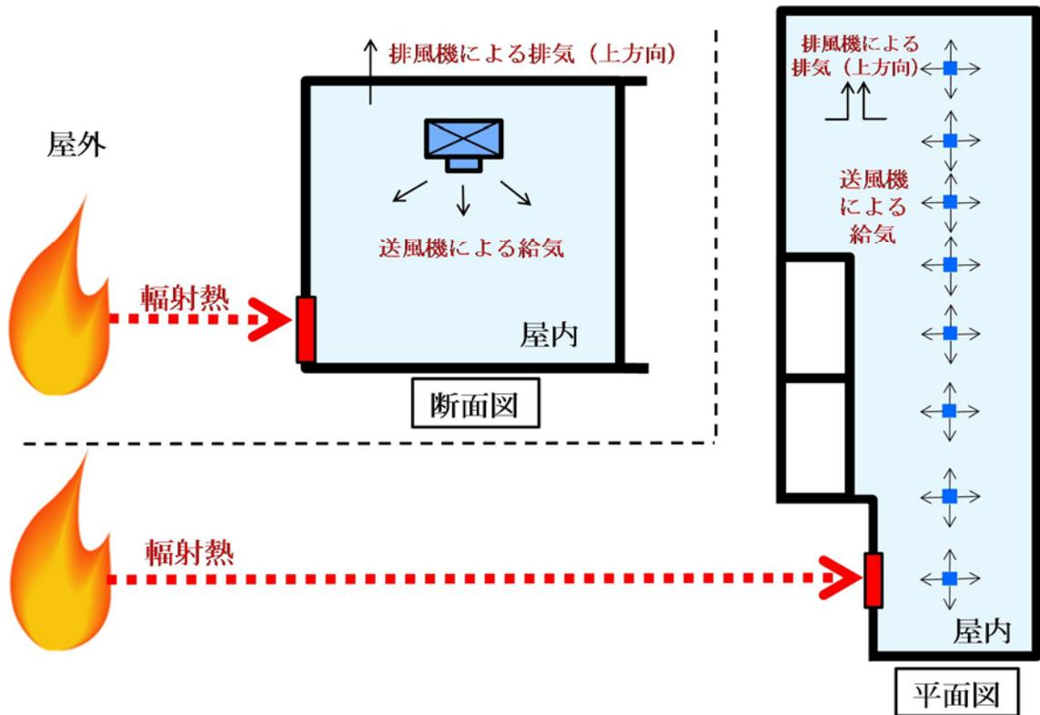
第 5.6.1.2-2 図 電気室内の給排気の概念図
