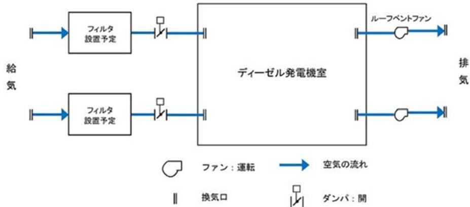
第 3.2-5 図 ディーゼル発電機室換気系の系統概略図
