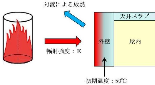
第 2. 1. 3. 3-1 図 建屋外壁の評価概念図
