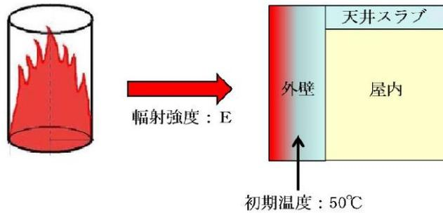
第 4. 1. 2. 3-1 図 建屋外壁の評価概念図
