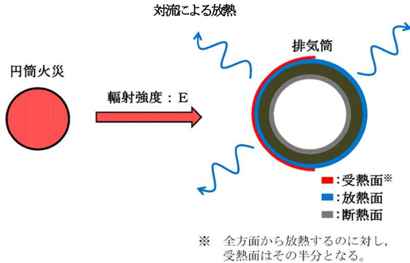
第 4.1.2.4-2 図 排気筒の評価概念図
