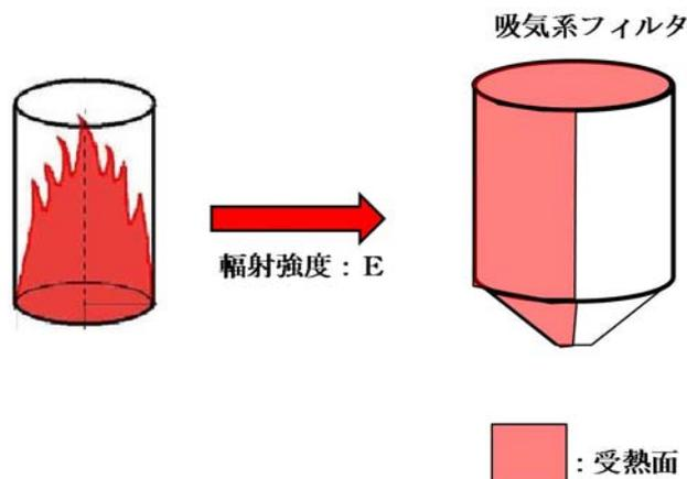
第 4.3.2-6 図 吸気系フィルタの評価概念図
