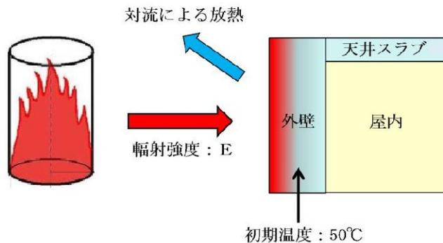
第 3. 2. 3-1 図 建屋外壁の評価概念図
