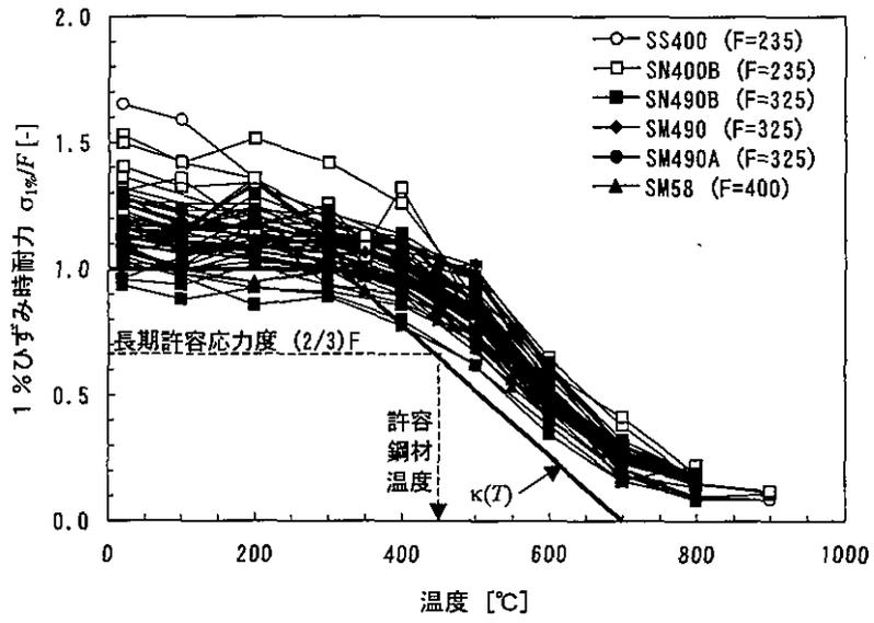
図5 各種鋼材の高温時の1%歪時耐力 (参考文献<sup>2)~6)</sup> のデータから作成)
