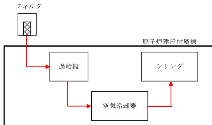
第 3. 1-1 図 ディーゼル発電機吸気系統概略図
