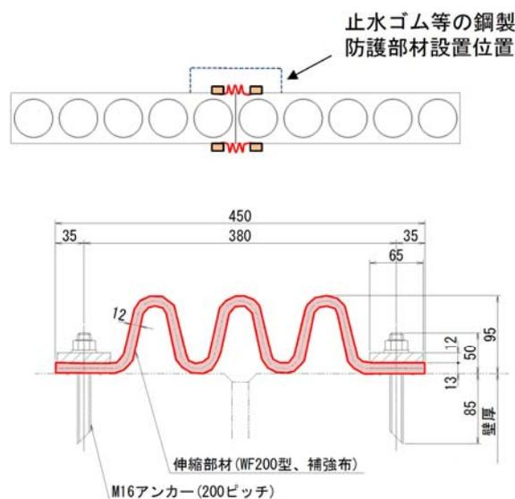
図3 止水ジョイント部の概要図
