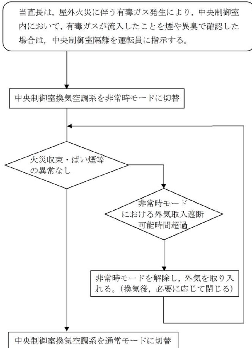
第 3.2-2 図 中央制御室換気空調系隔離作業フロー図
