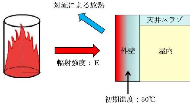
第 5.3-1 図 建屋外壁の評価概念図
