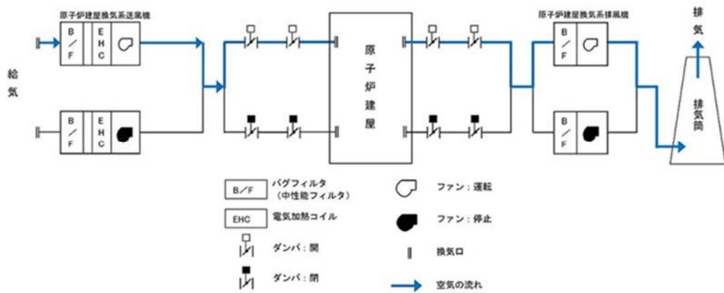
第 3.2-3 図 原子炉建屋換気系の系統概略図
