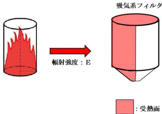
第 4.1.2.5-2 図 吸気系フィルタの評価概念図
