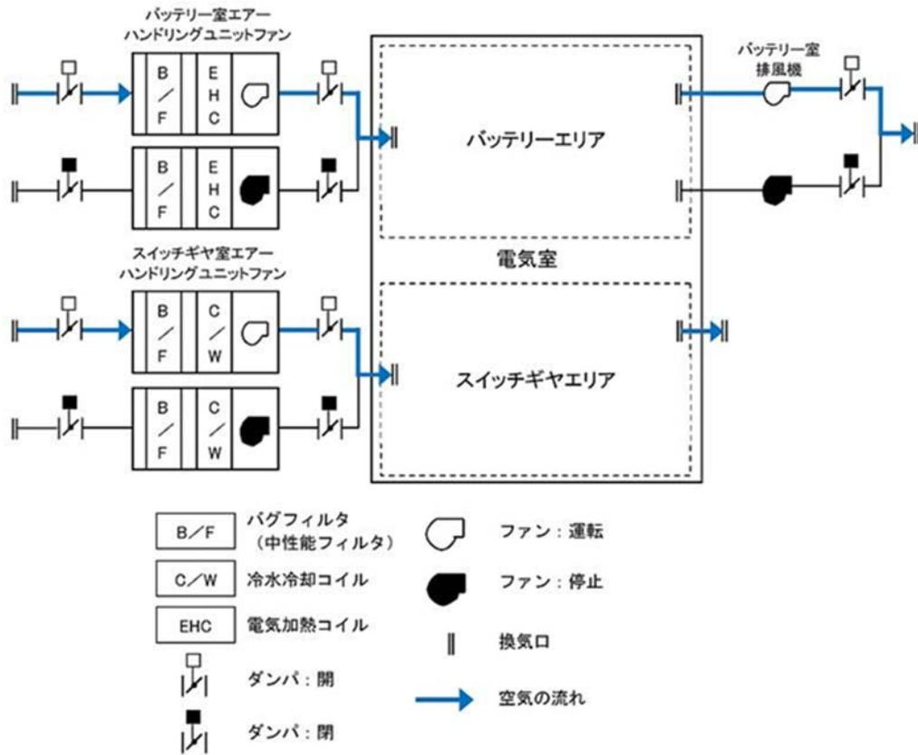
第 2.4.2-4 図 電気室換気系の系統概略図
