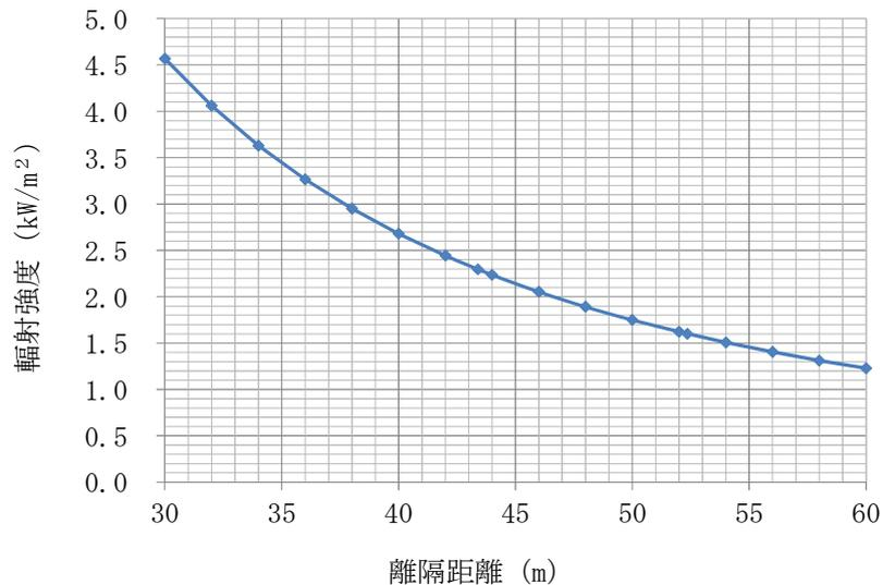
図 1 離隔距離と輻射強度の相関図
