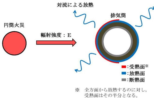
第 2. 1. 3. 3-3 図 排気筒の評価概念図
