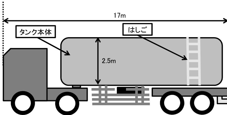
第 4.2.2-1 図 燃料輸送車両概要図
