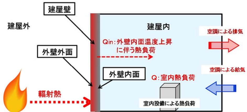
第 4.3.2-4 図 室内温度評価の概念図
