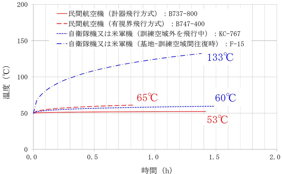
第 5.3-4 図 原子炉建屋外壁の温度変化
