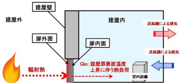
第 5.6.1.2-1 図 室内温度評価の概念図
