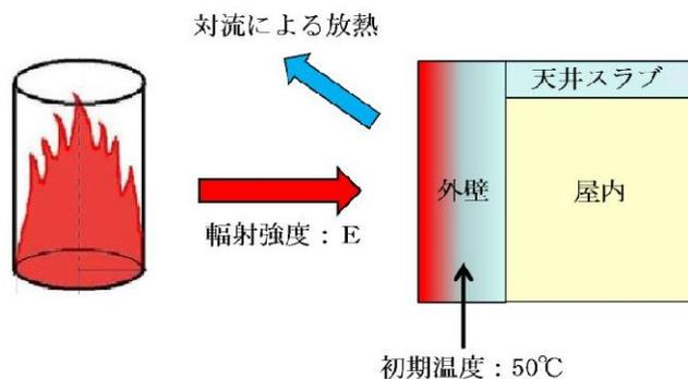
第 2. 2. 3-1 図 建屋外壁の評価概念図
