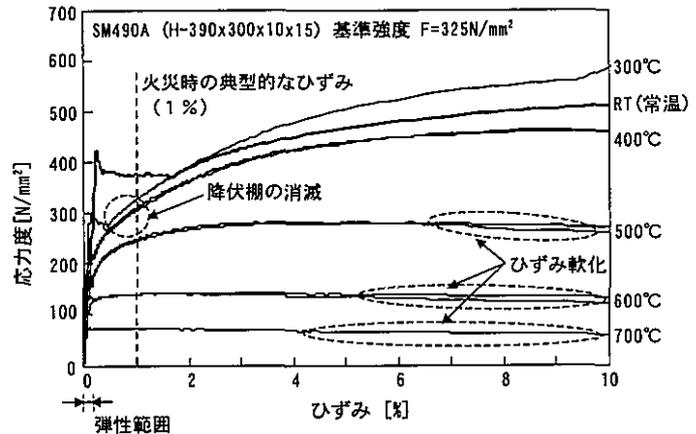
図4 構造用鋼材の応力-歪曲線の例<sup>2)</sup>
