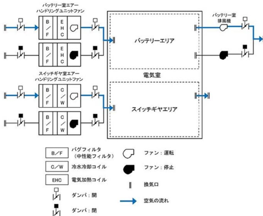
第 3.2-4 図 電気室換気系の系統概略図
