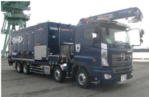
可搬型代替注水大型ポンプ
