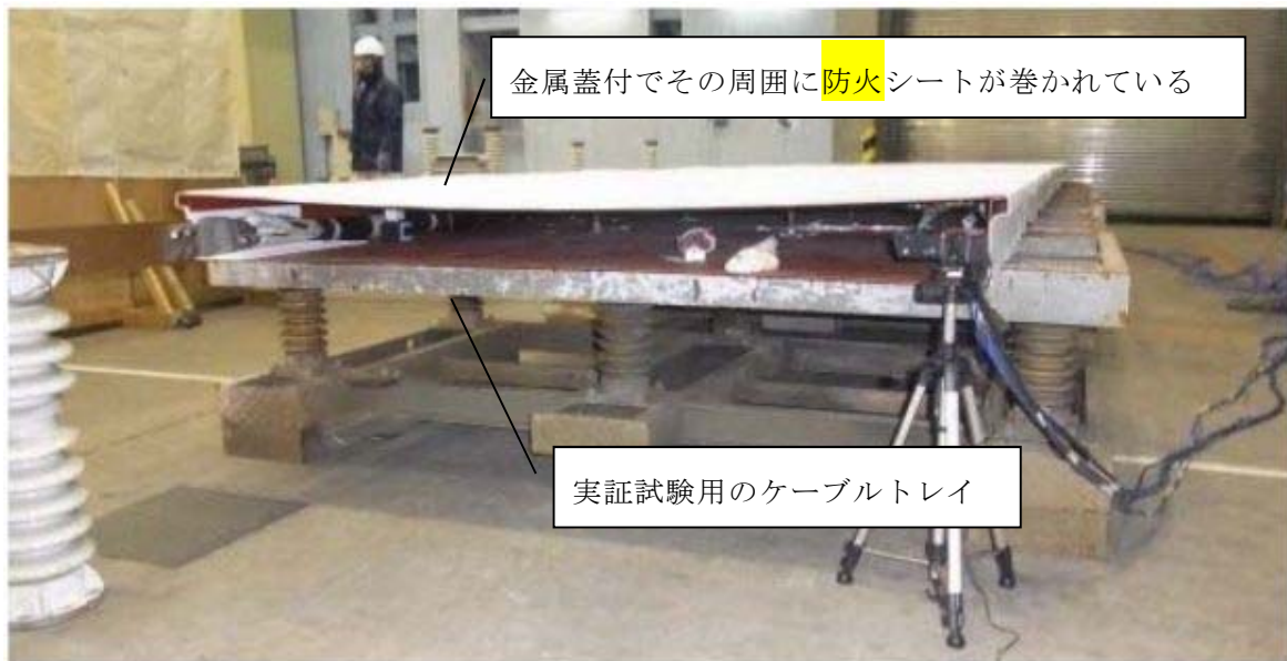
第 3 図 実証試験用のケーブルトレイ
