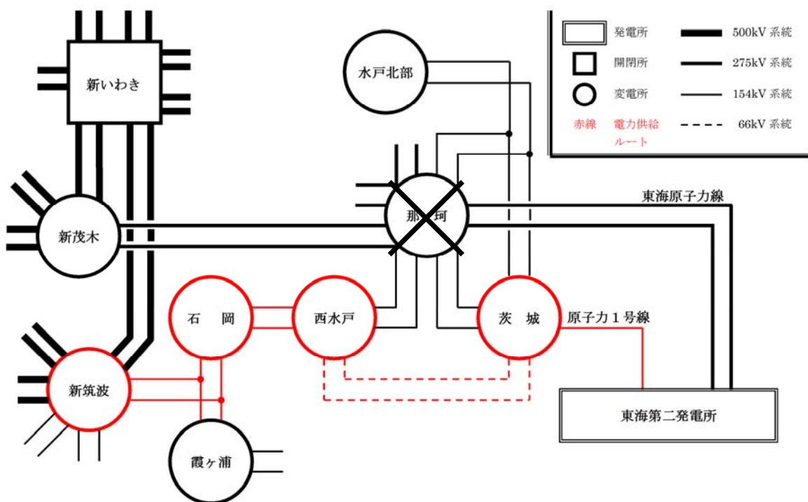
第 3 図 那珂変電所全停時の供給系統
