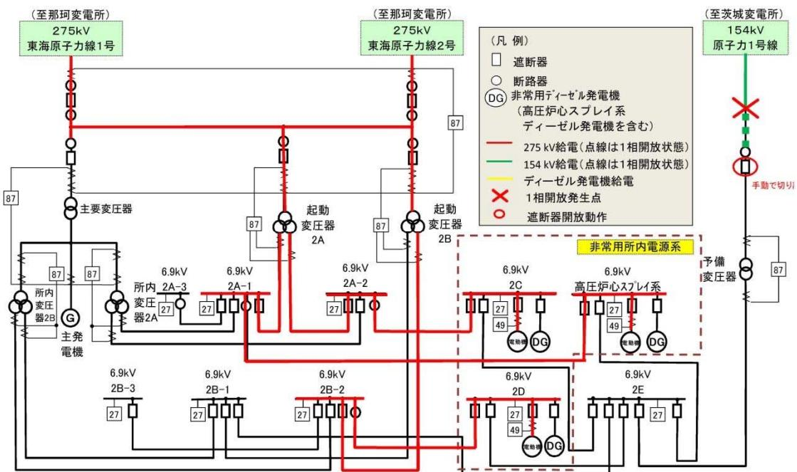
第 6 図 故障箇所を隔離した状態
