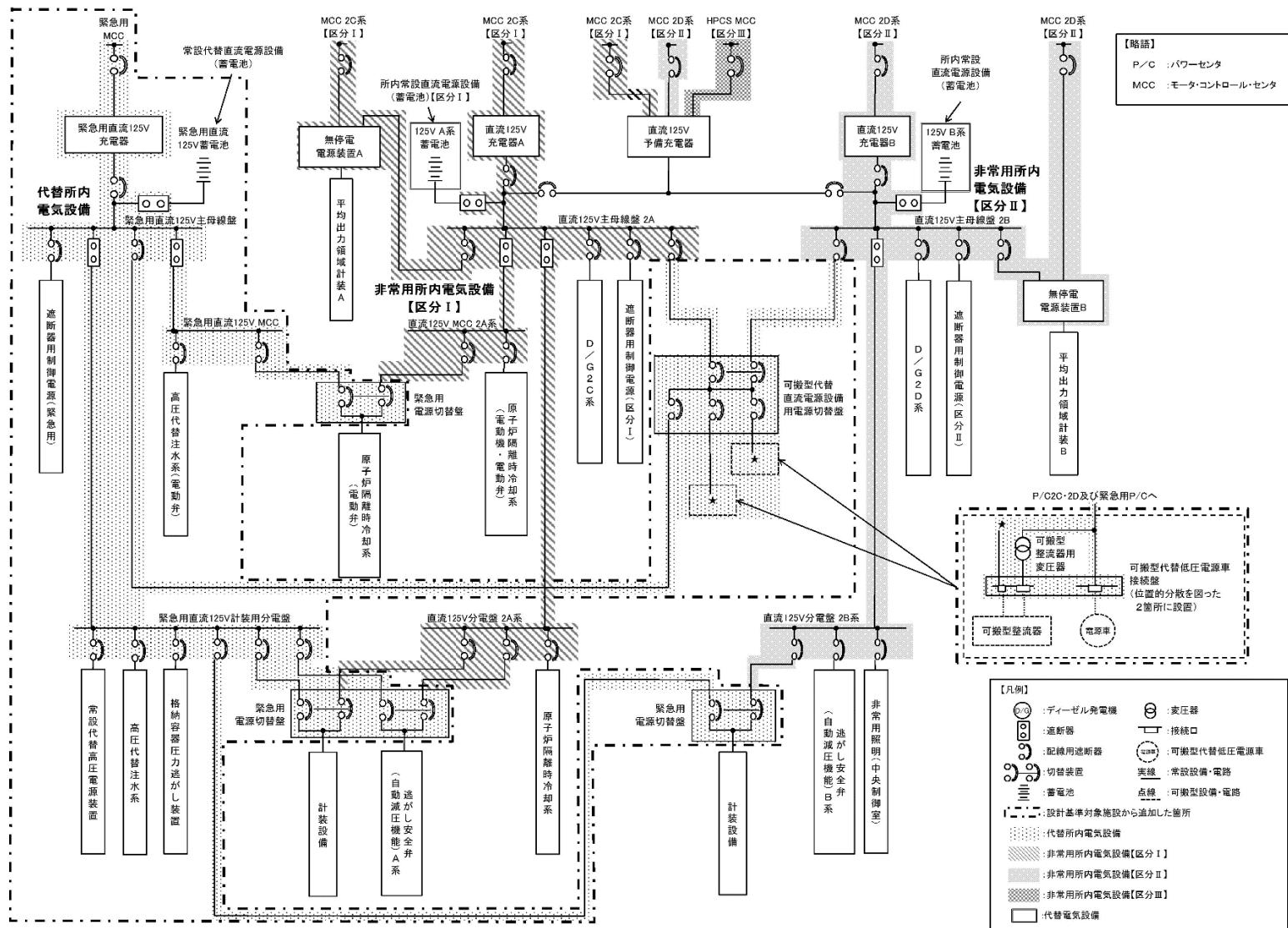
第 10.1-3 図 直流電源单線結線図 (1/3)
