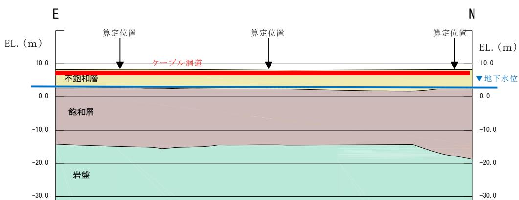
第6図 搖すり込み沈下量算定位置図
