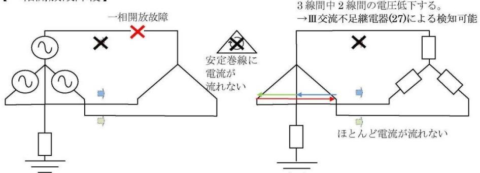
第 2.2.1.1-11 図 交流不足継電器 (27) による検知 (イメージ)
