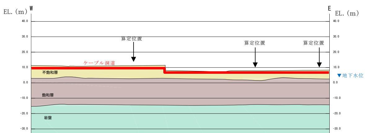
第4図 搖すり込み沈下量算定位置図
