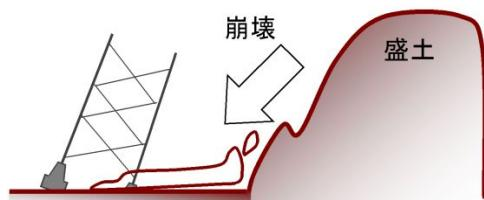
→送電鉄塔近傍に大規模な盛土がある箇所を抽出し、リスク評価する。
