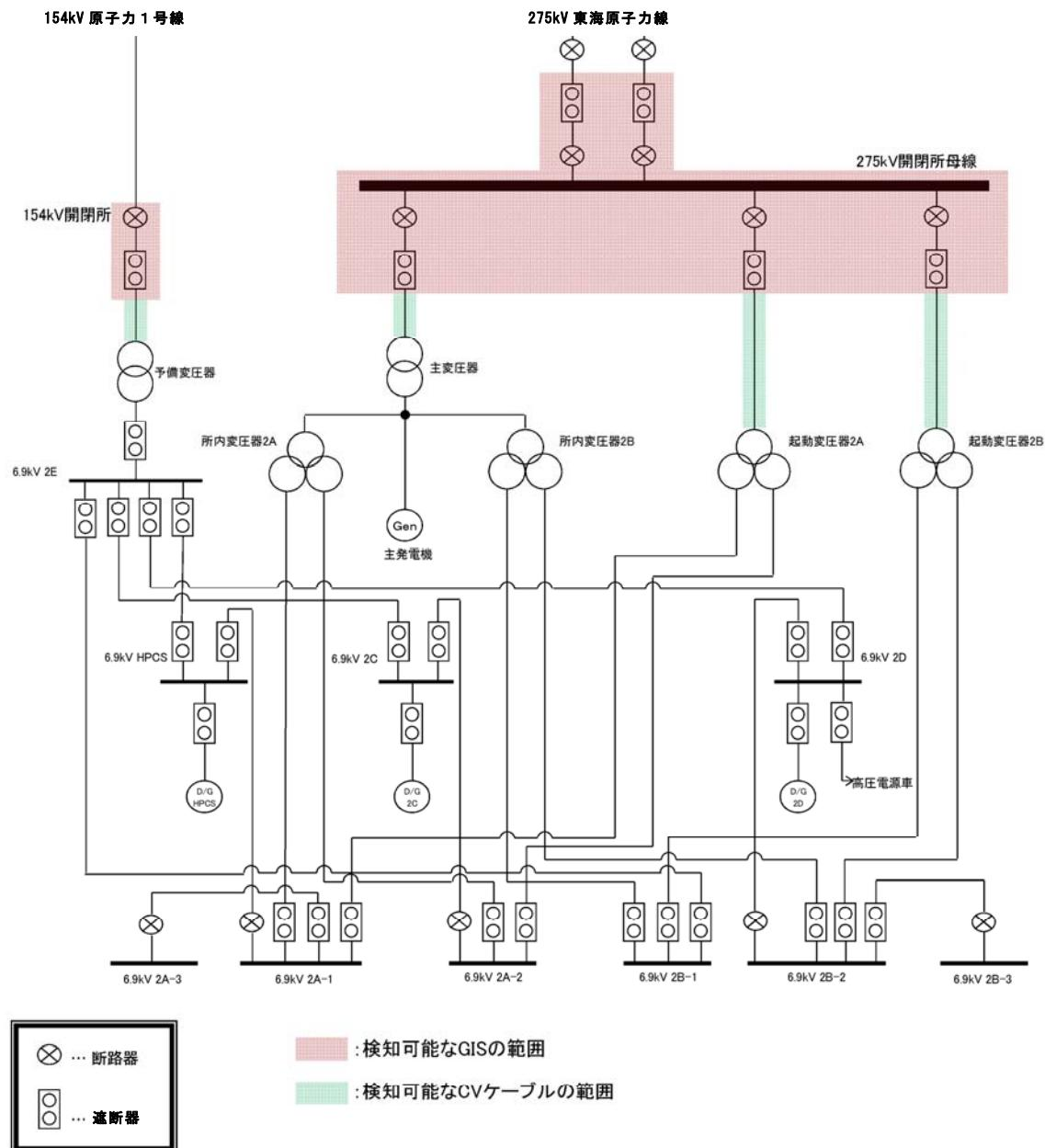
第2図 完全地絡による電流差動継電器（87）による検知部位
