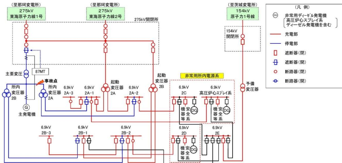
第 2.2.1.1-4 図 所内変圧器保護装置
