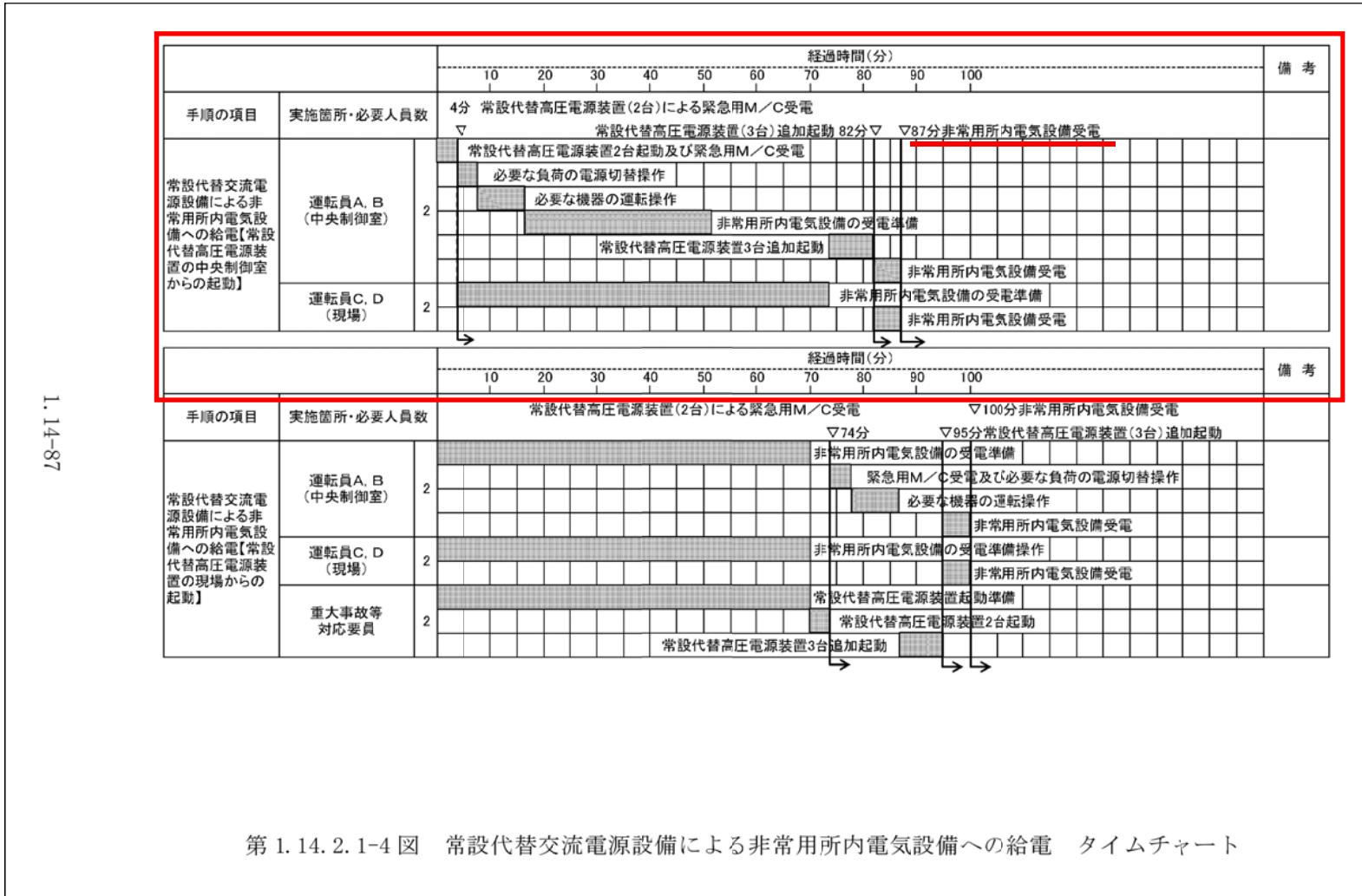
第1.14.2.1-4図 常設代替交流電源設備による非常用所内電気設備への給電 タイムチャート
