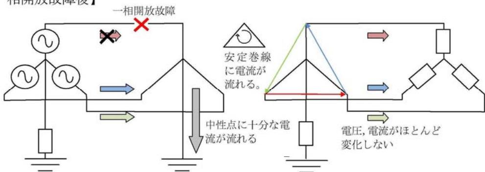
第 2.2.1.1-7 図 変圧器一次側における 1 相開放故障による
