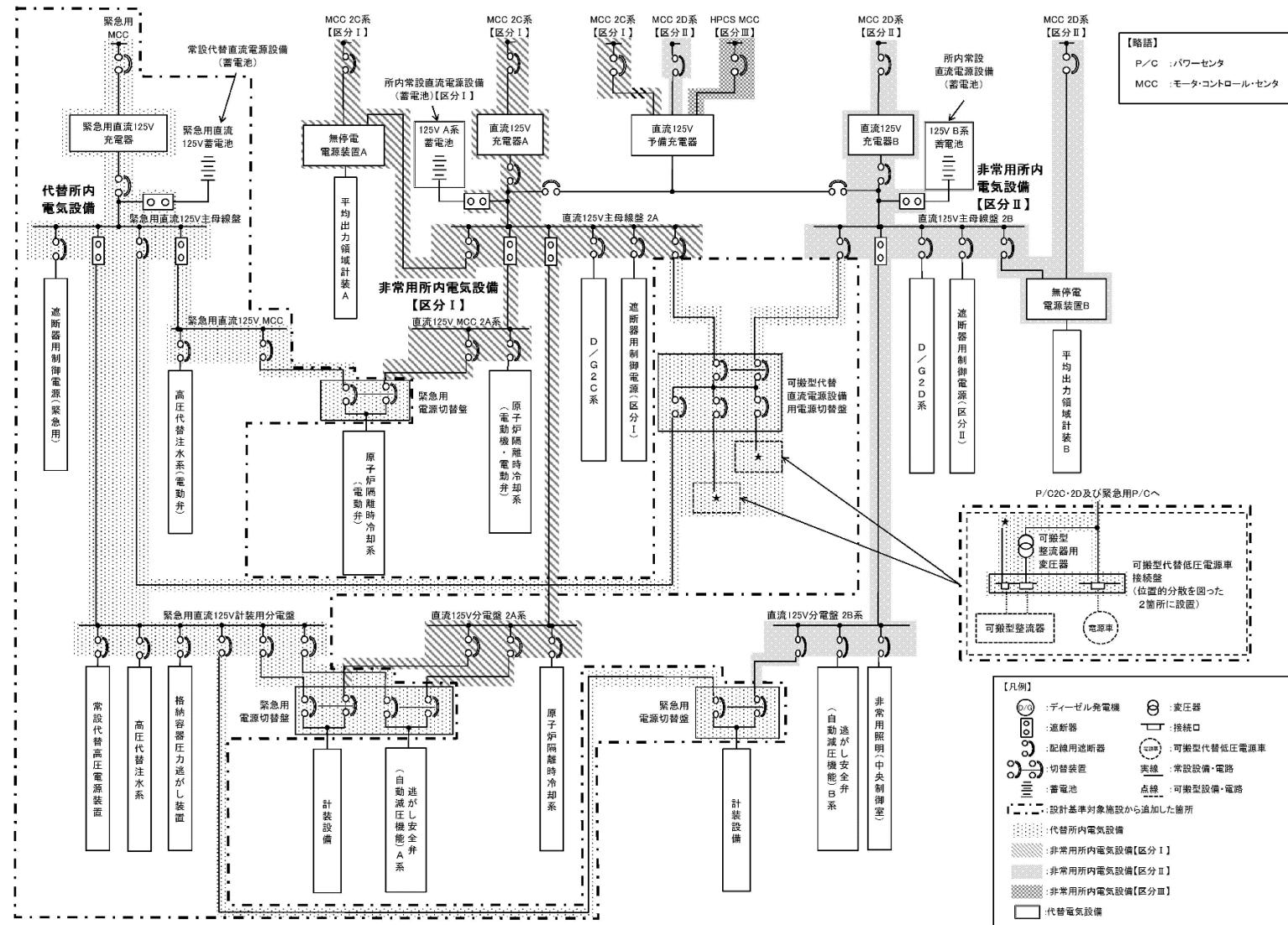
第 2.1.1-3 図 直流電源单線結線図 (1/3)
