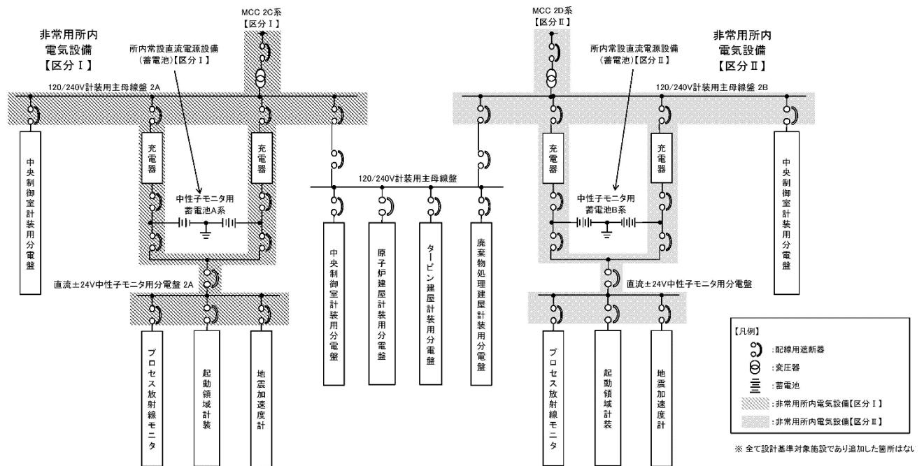
第 2.1.1-3 図 直流電源单線結線図 (2/3)
