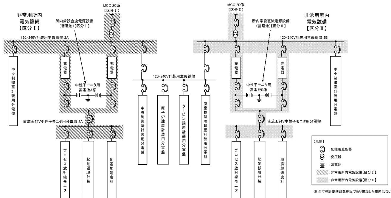
第 10.1-3 図 直流電源单線結線図 (2/3)
