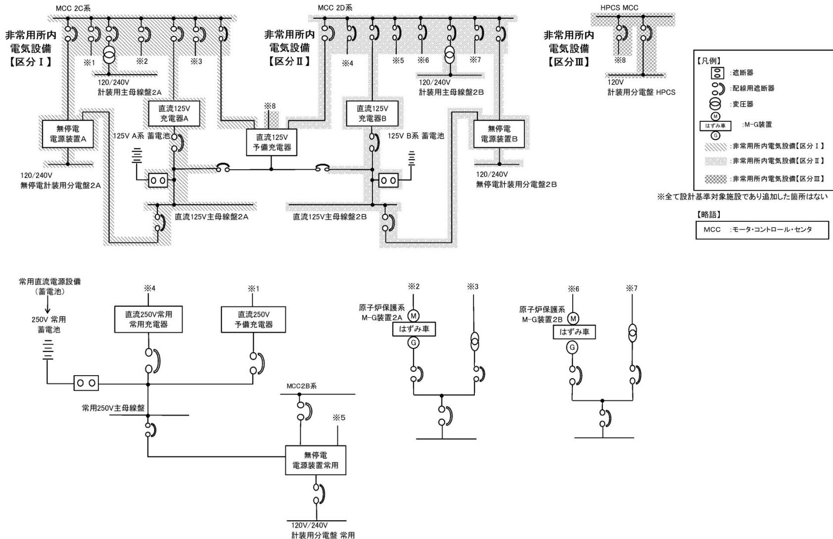
第 10.1-4 図 計測制御用電源单線結線図
