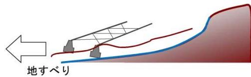
→地滑り防止地区、地滑り危険箇所、地滑り地形分布図をもとに地滑り箇所を抽出し、リスク評価する。
