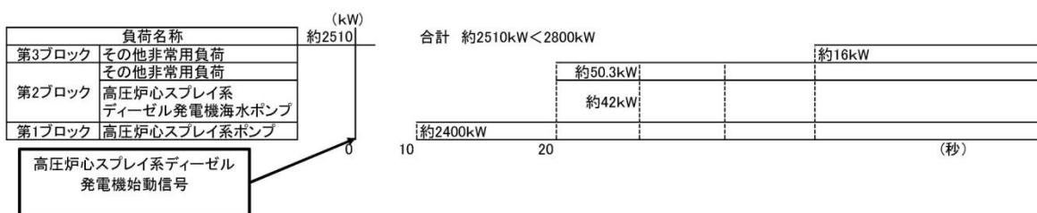
第 2.3.1.2-3 図 高圧炉心スプレイ系ディーゼル発電機の負荷の始動順位
