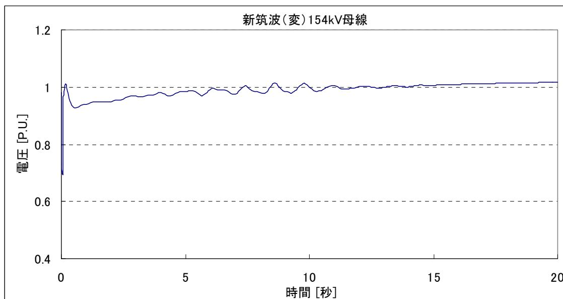
第 14 図 電圧シミュレーション結果
