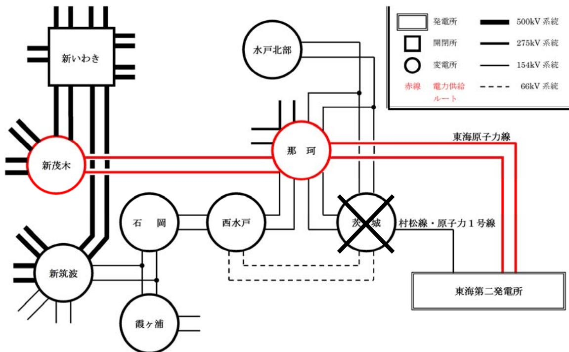
第 2.2.2.2-4 図 茨城変電所全停時の供給系統
