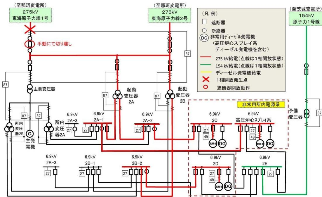
第3図 故障箇所を隔離した状態
