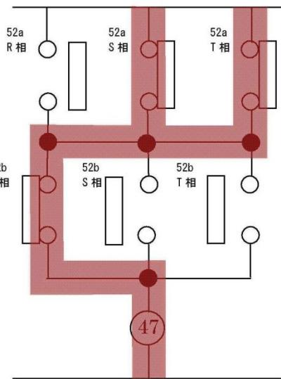
第4図 遮断器投入不良による1相開放故障検知インターロック概要
