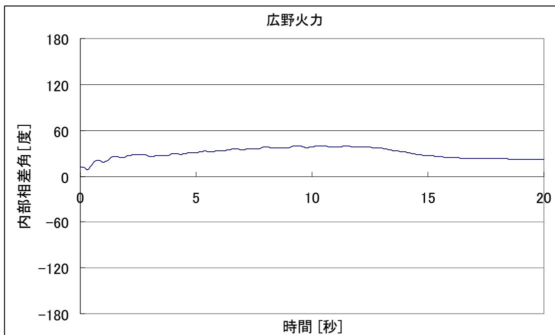
第 13 図 安定度シミュレーション結果（広野火力発電所）
