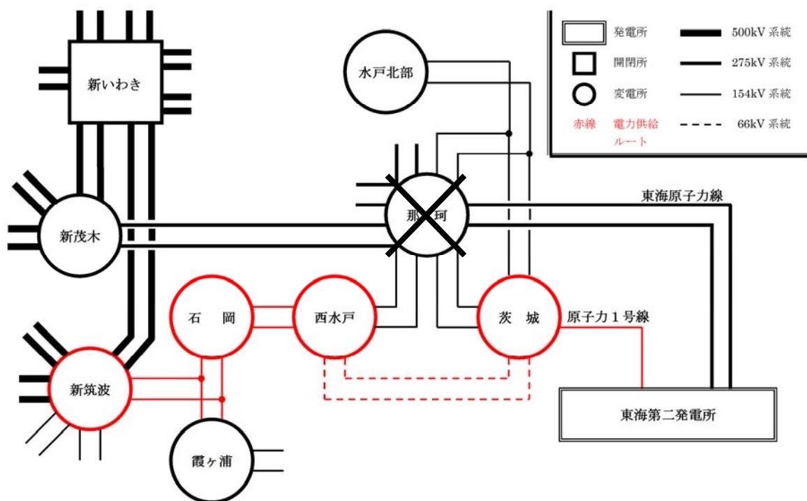
第 2.2.2.2-3 図 那珂変電所全停時の供給系統
