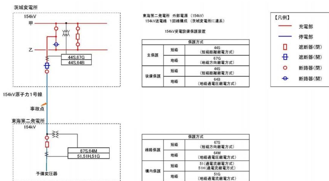
第 2.2.1.1-2 図 送電線保護装置（154kV 原子力 1号線故障時）
