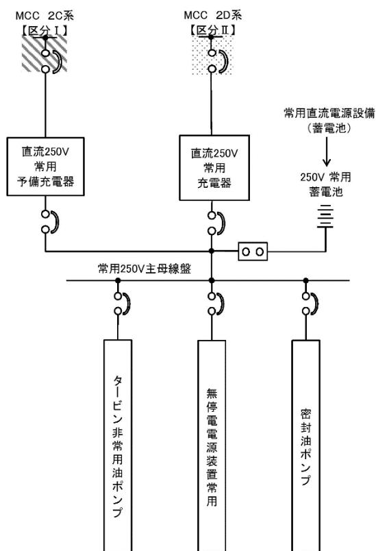
第 2.1.1-3 図 直流電源单線結線図 (3/3)
