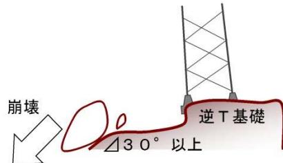
→急傾斜地（30°以上）で土砂崩壊が発生する可能性がある箇所を抽出し、リスクを評価する。
