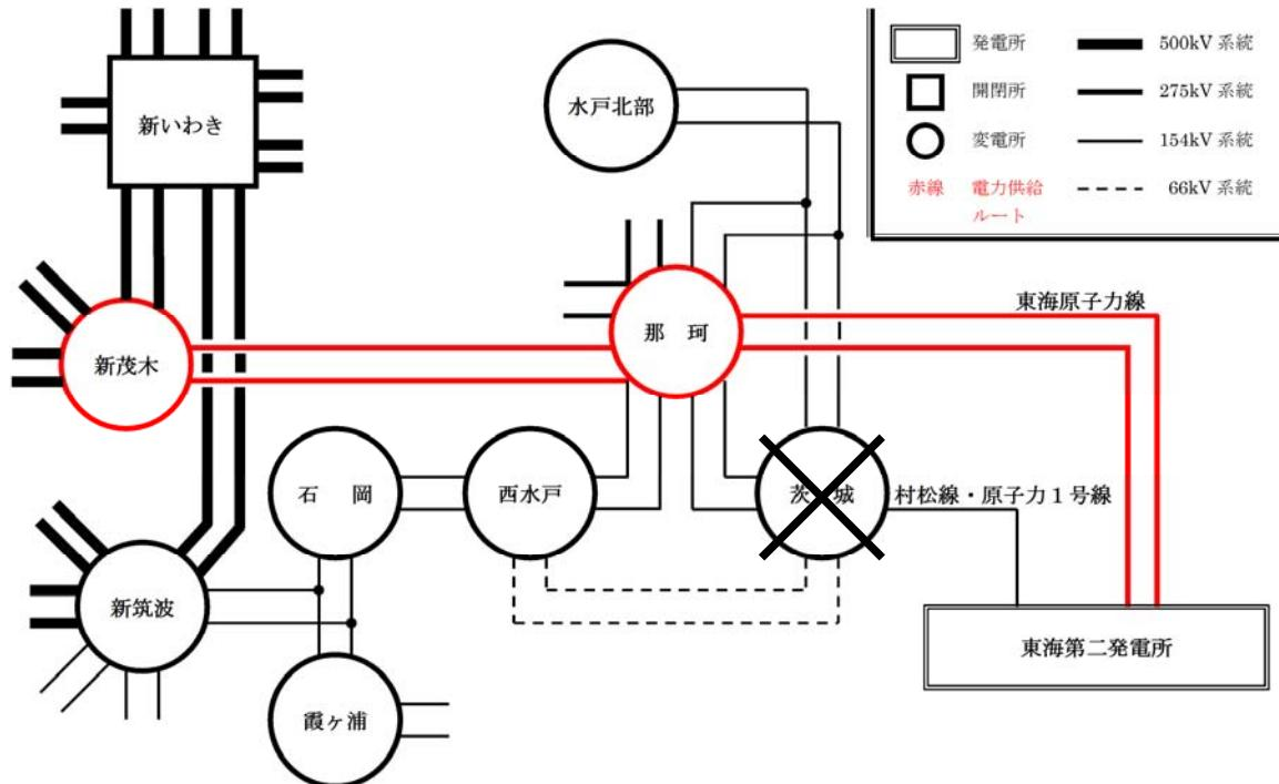
第15図 茨城変電所全停時の供給系統
