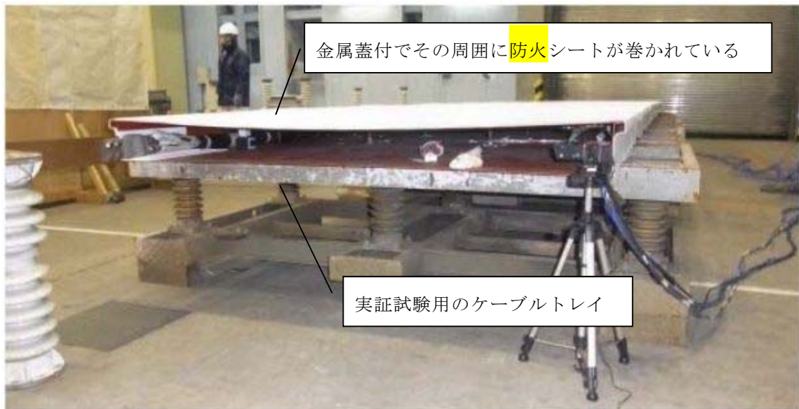
第3図 実証試験用のケーブルトレイ
