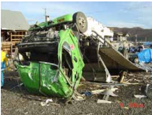
第 6.3-4 図 竜巻による被災後の 4 t トラックの様子 (28)(29)
