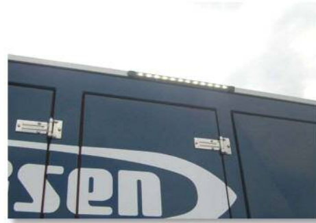
車両の作業用照明
