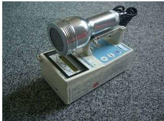
第5.2-2 図 GM汚染サーベイメータ
