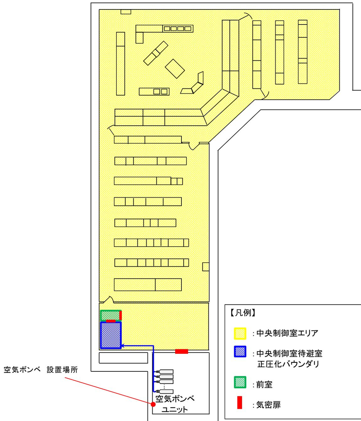
第59-3-5図 中央制御室待避室ポンベユニット（空気ポンベ）配置図
