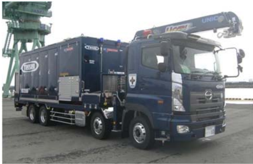
可搬型代替注水大型ポンプ
