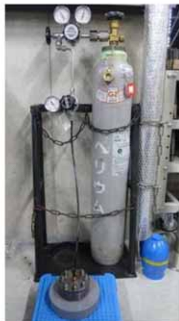
図 1 2 He 気密確認試験状況
