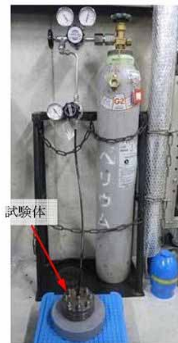
図5 He 気密確認試験状況
