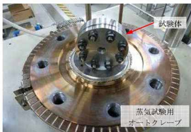
図4 蒸気曝露試験体設置状況
