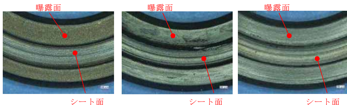
図7 試験後外観観察結果 (a: 乾熱 200℃, 168h, b, c: 蒸気 250℃, 168h)
