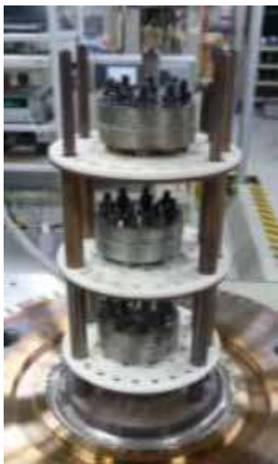
図 3 蒸気曝露 試験片設置状況
