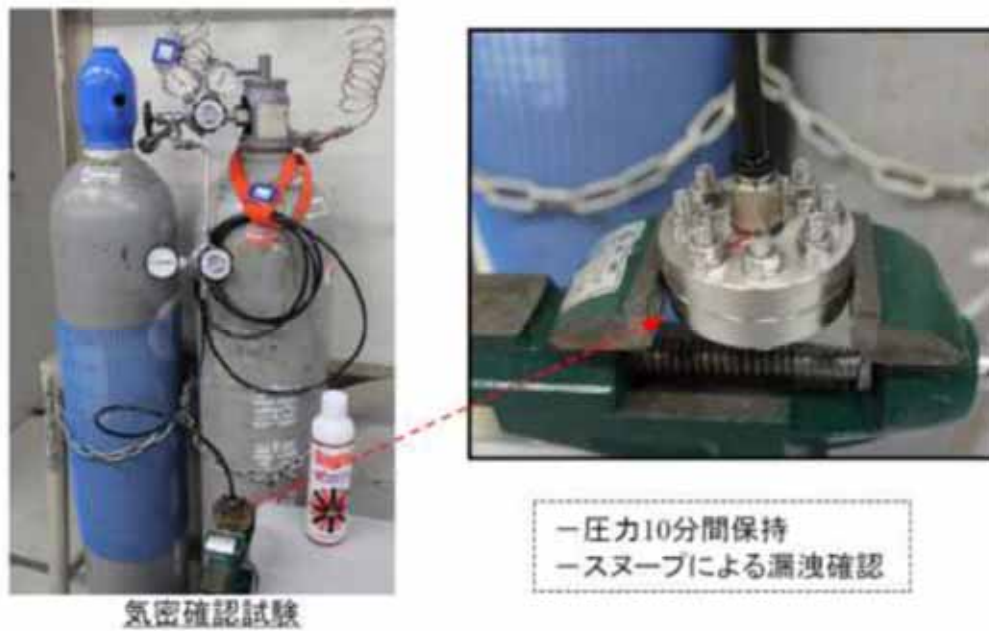
第 2-12 図 バックアップシール材の気密試験
