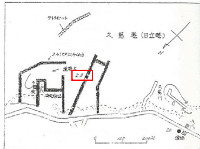
1960年チリ地震津波による久慈港(日立港)の津波の高さ (チリ津波合同調査班(1961)に加筆)
