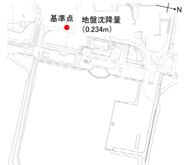
東海第二発電所内基準点測量位置
