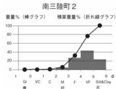
千葉県一宮町(左)と宮城県南三陸町(右)における東北地方太平洋沖地震津波の津波堆積物の粒度分布曲線(青野(2012))
