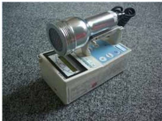
第 5.2-2 図 GM汚染サーベイメータ
