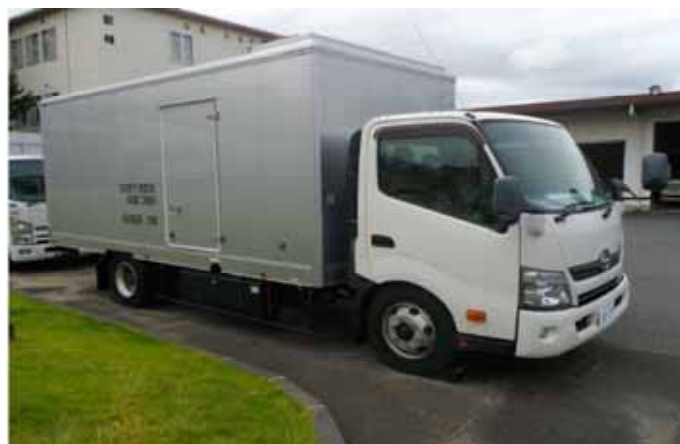
可搬型代替低圧電源車
