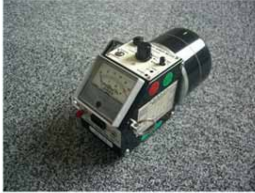
第 5.2-3 図 電離箱サーベイメータ
