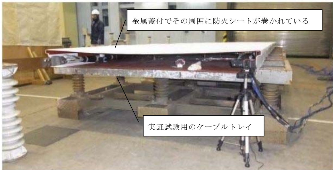
第 3 図 実証試験用のケーブルトレイ
