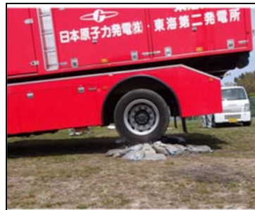
第1図 乗越え検証試験状況 (2/2)
