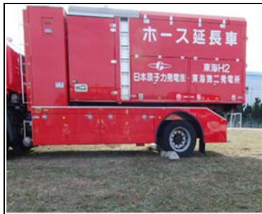
第1図 乗越え検証試験状況 (2/2)
