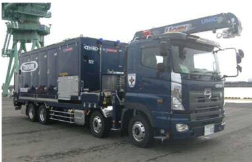
可搬型代替注水大型ポンプ
