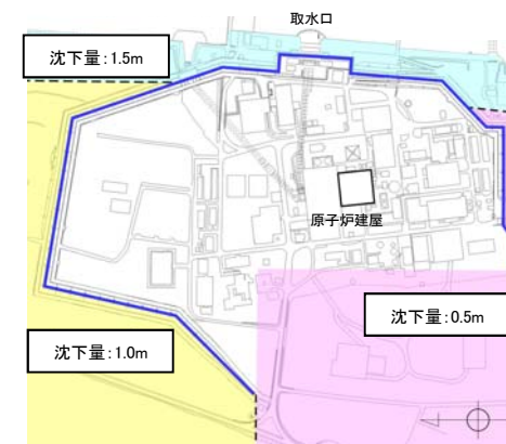
地盤の変状の沈下量
