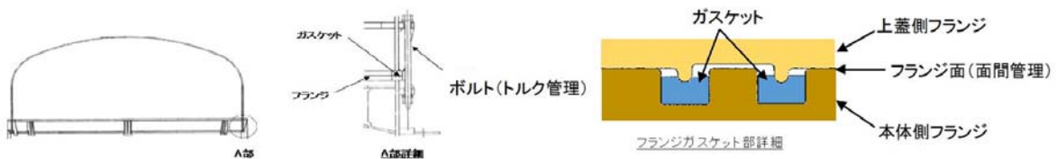
図 1 トップヘッドフランジ部の構造
