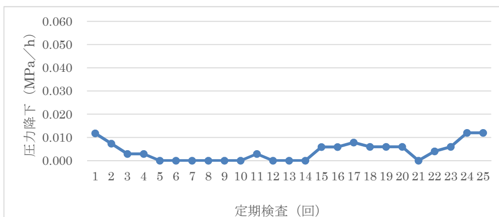
図3 トップヘッドフランジ部リークテスト実績
