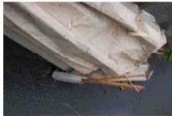
飛散した折板屋根の損傷状況
