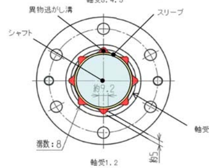
図5 ディーゼル発電機用海水ポンプ軸受部
