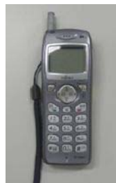
電力保安通信用電話設備 (携帯型)
