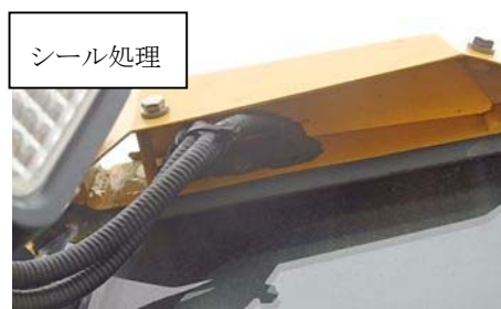
第1図 可搬型設備 小動物対策例 (2/2)
