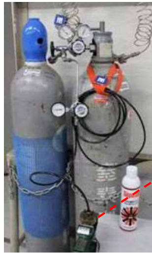
図5 気密確認試験状況
