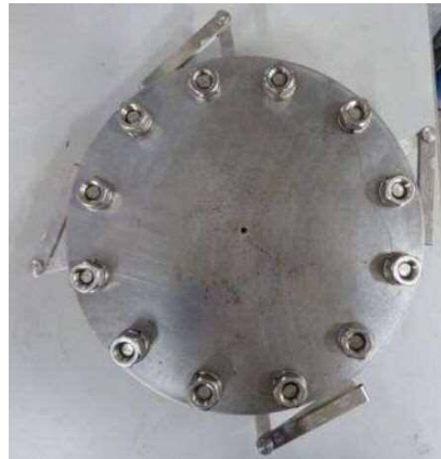
図8 変位付与状況 隙間ゲージを用いて所定の変位を加えた後、 隙間ゲージを抜いて再締め付け
