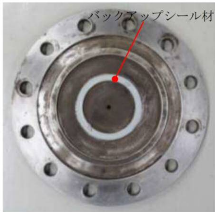
図7 バックアップシール材塗布状況 (1.5mm 厚さ)
