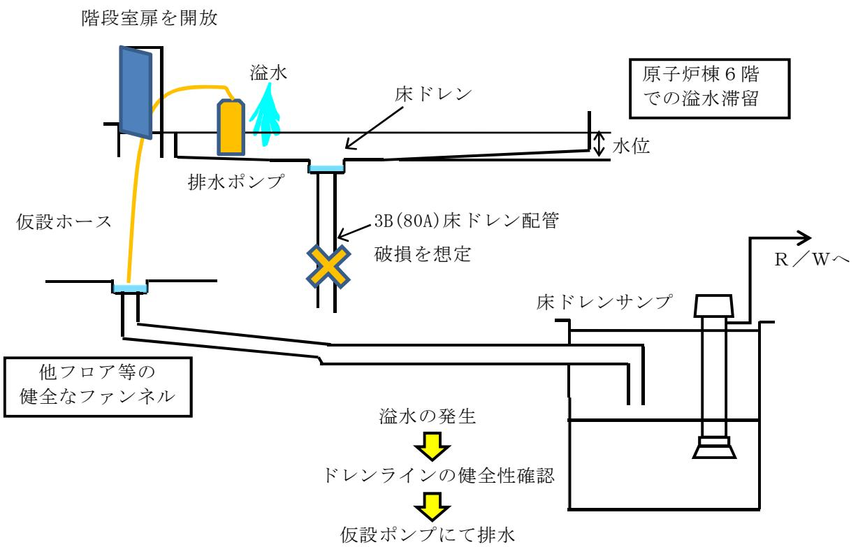
第2図 地震時の床ドレンファンネル破損・閉塞時における排水処理について
