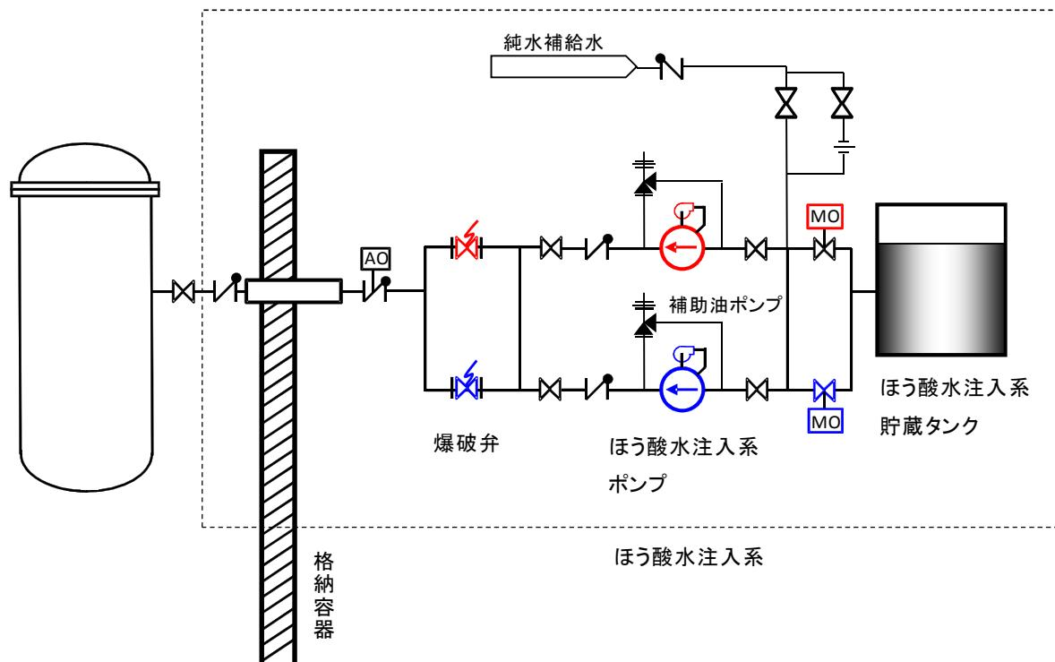
第1図 ほう酸水注入系概略系統図
