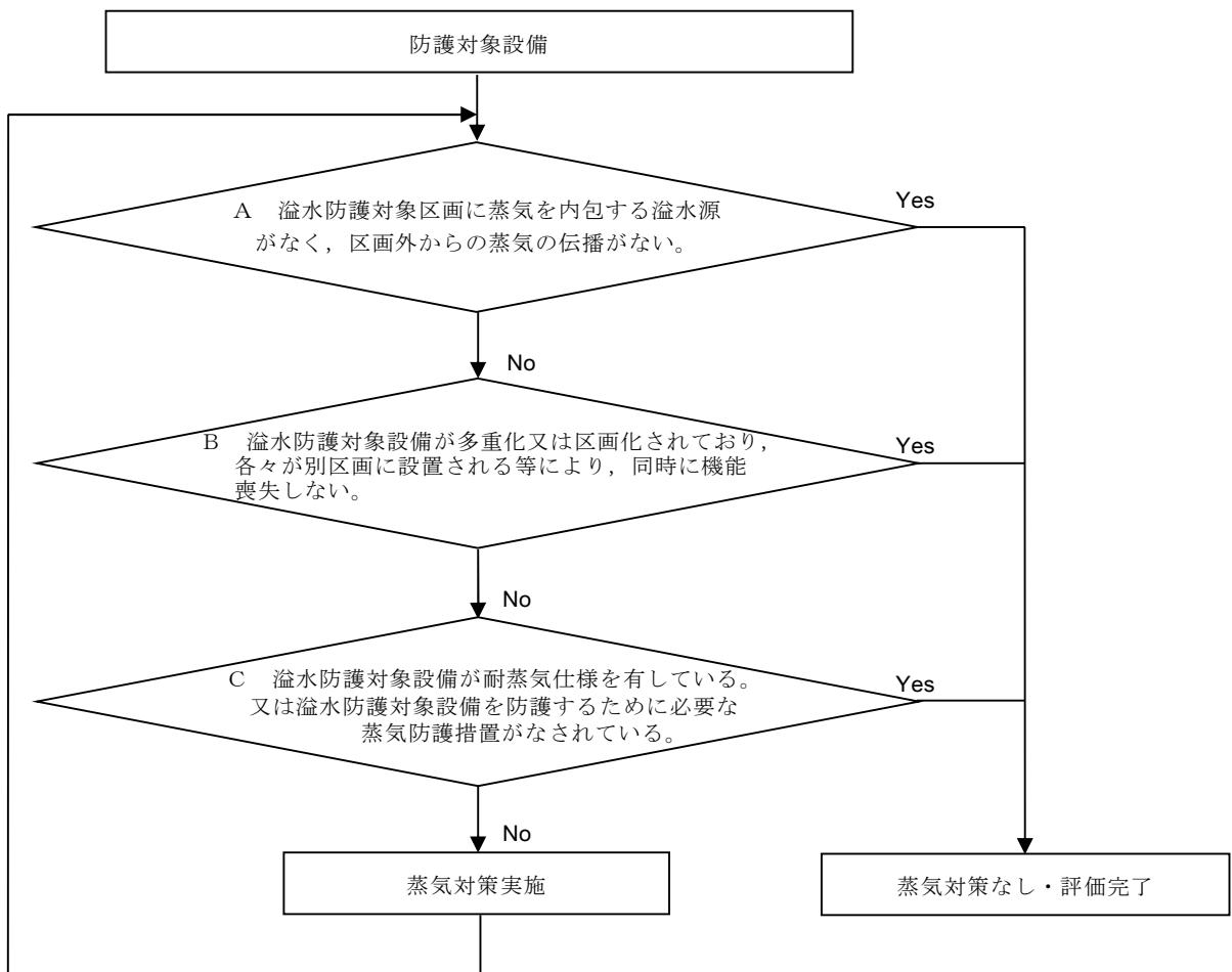
第 6.4-1 図 蒸気影響評価フロー
