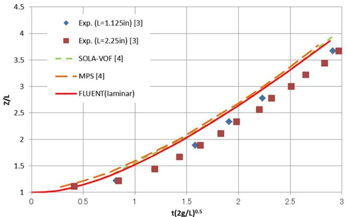
第5図 先端位置  $Z$  の時間変化
