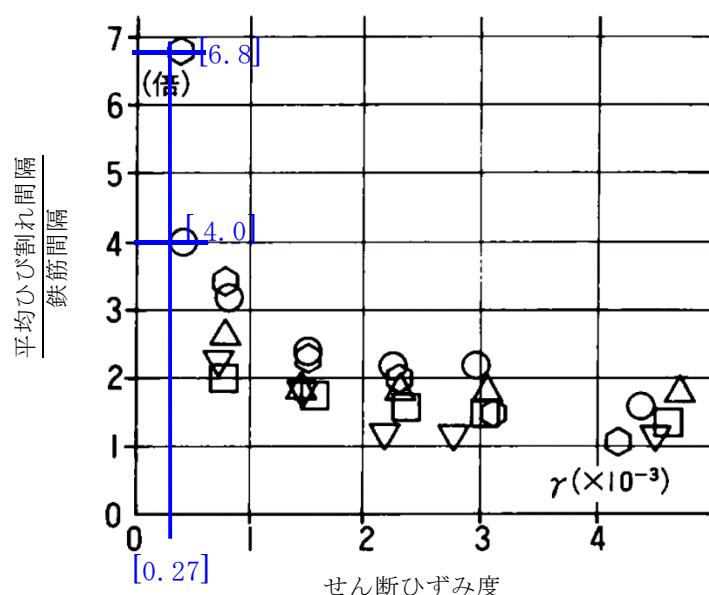
第4図 (平均ひび割れ間隔) / (鉄筋間隔)
