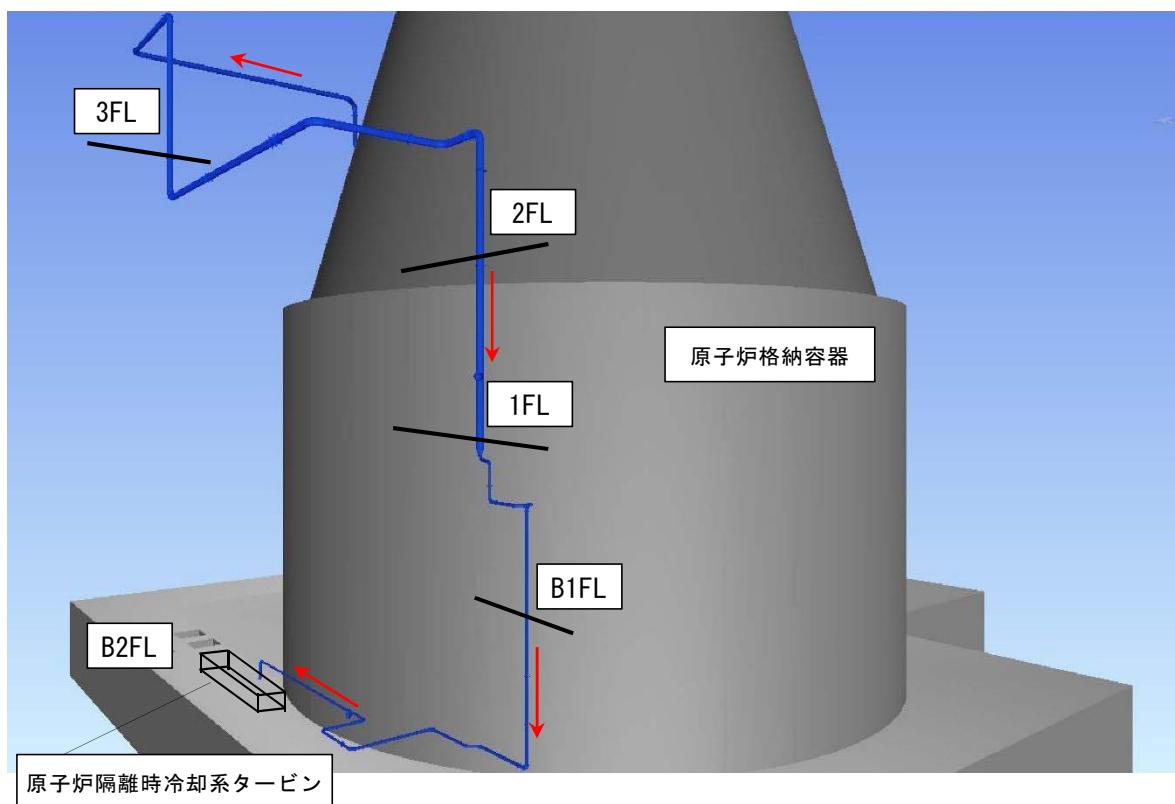
第3図 原子炉隔離時冷却系蒸気供給配管ルート図
