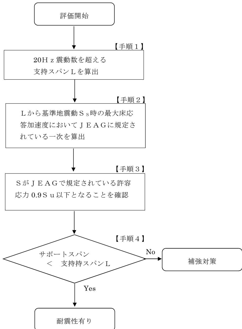
第6図 定ピッチスパン法を用いた耐震性評価フロー
