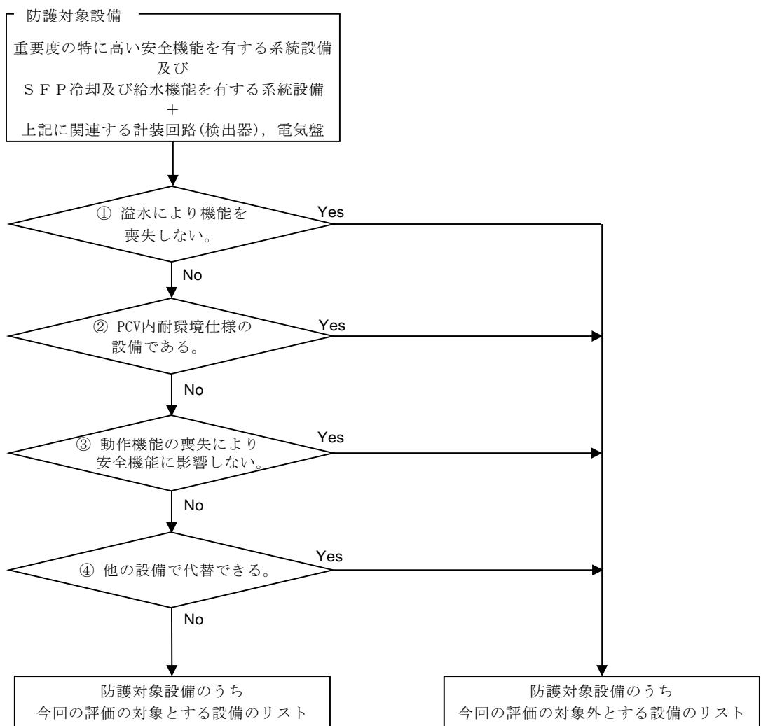
第 2.2-2 図 防護対象設備のうち溢水影響評価対象の選定フロー
