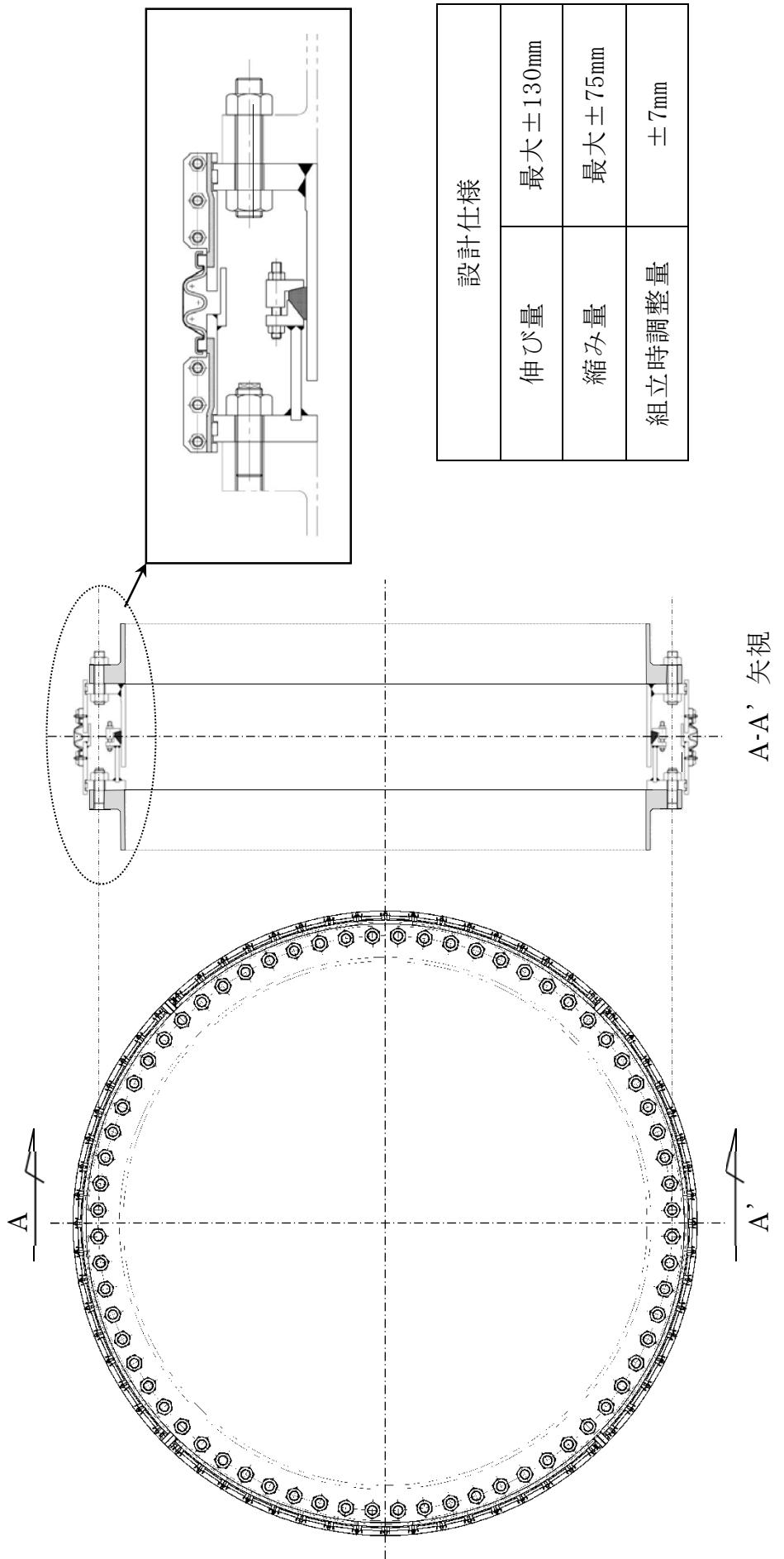
第2図 循環水ポンプ出口配管伸縮継手構造図
