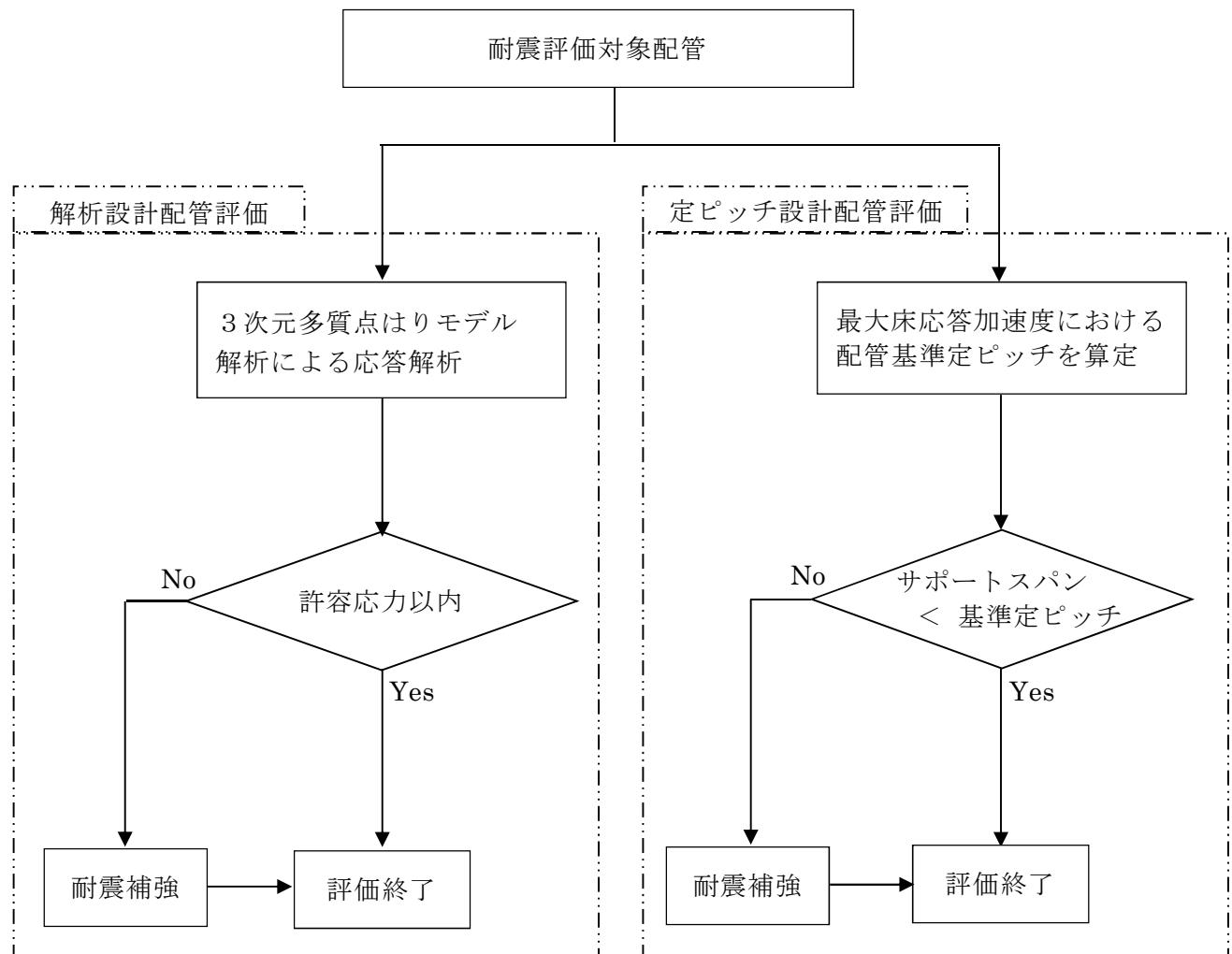
第1図 耐震B, Cクラス配管の評価フロー図
