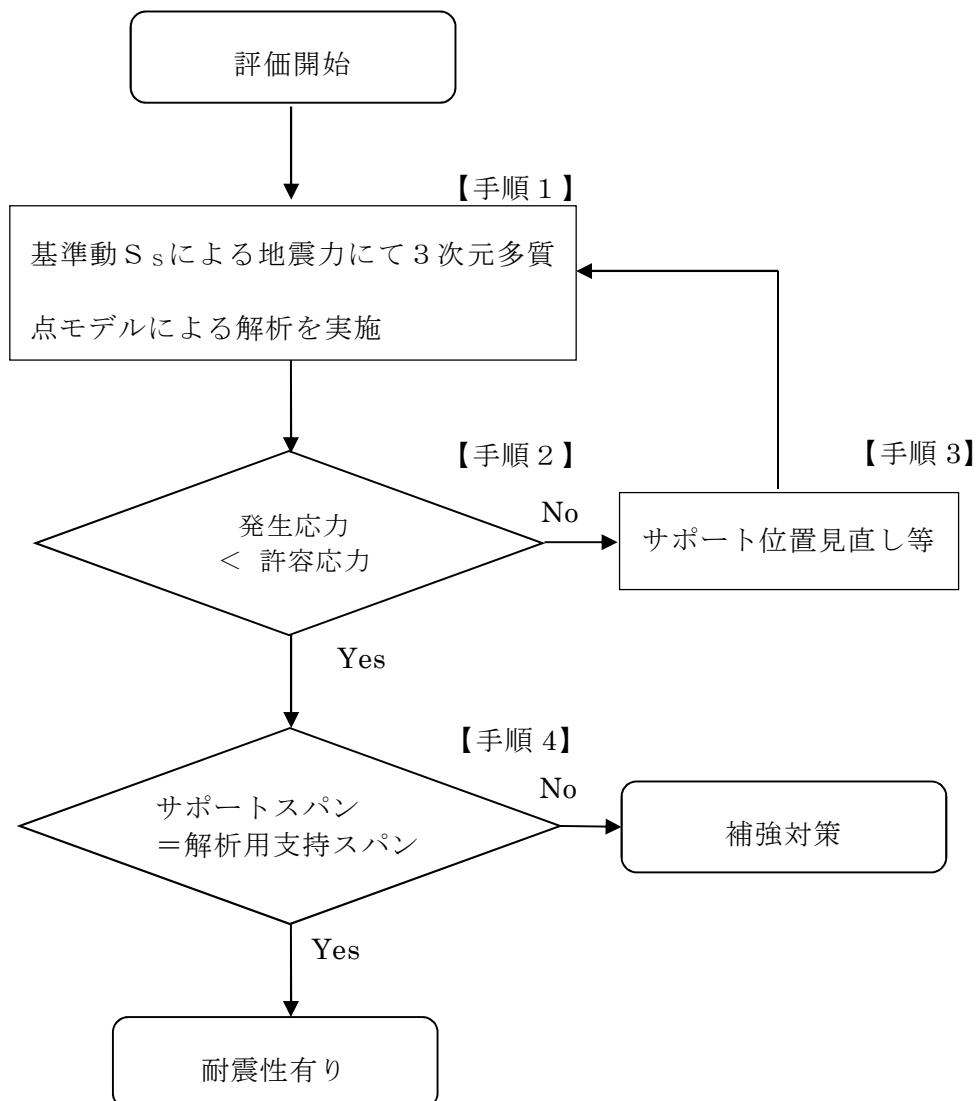
第5図 3次元多質点はりモデルを用いた耐震性評価フロー
