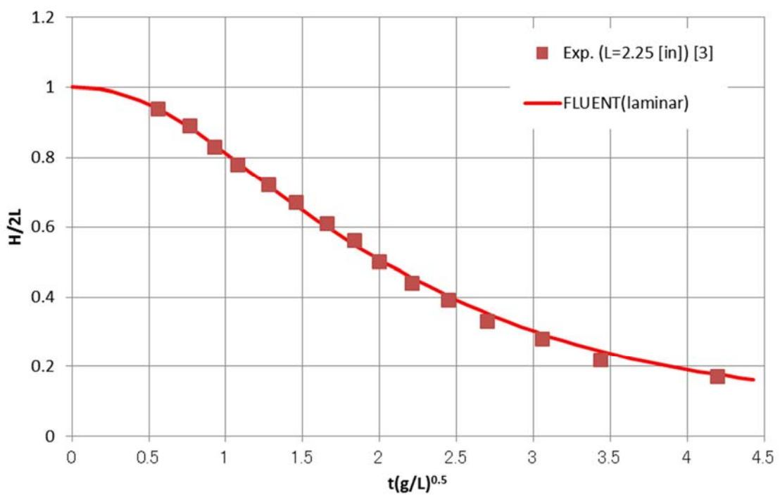
第6図 水柱高さ  $H$  の時間変化
