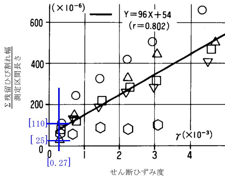
第3図 (残留ひび割れ幅の総計) / (測定区間長さ)
