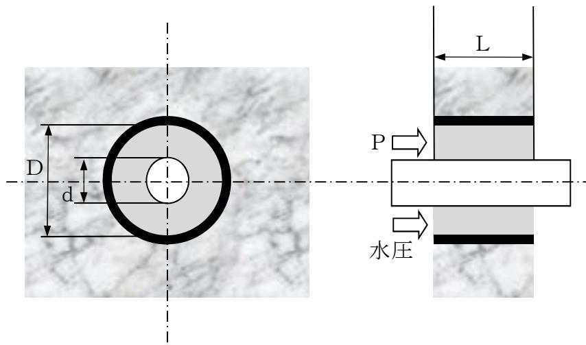
第2図 モルタル評価モデル概念図
