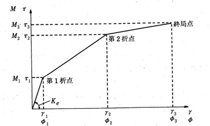
図4-1 トリリニヤー・スケルトンカーブ
