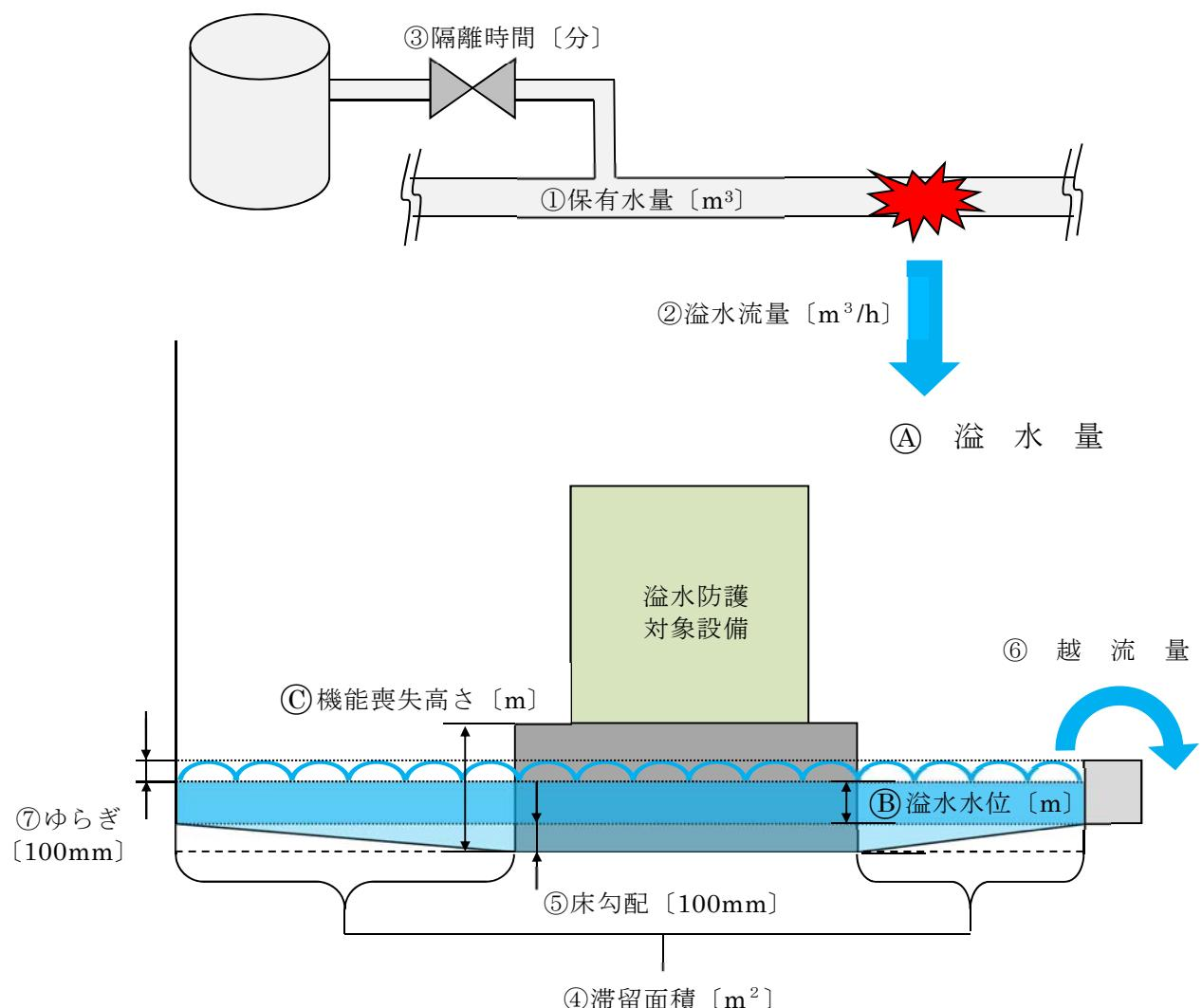
第1図 内部溢水影響評価に用いる各項目の概要図
