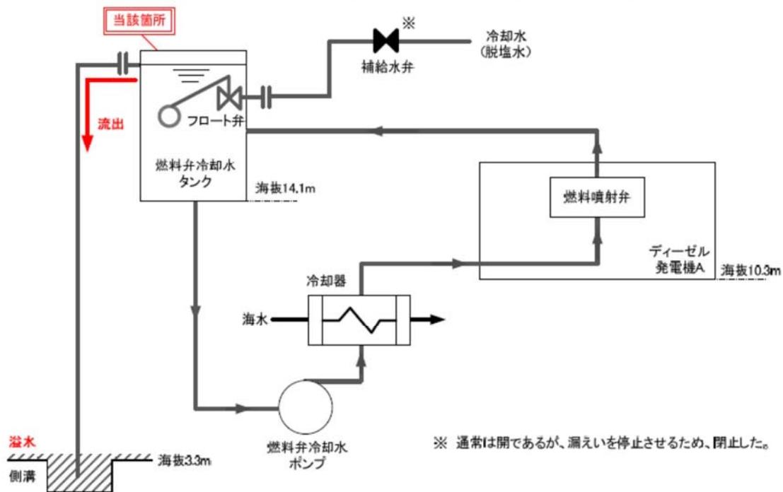
第1図 非常用ディーゼル発電設備 系統概略図
