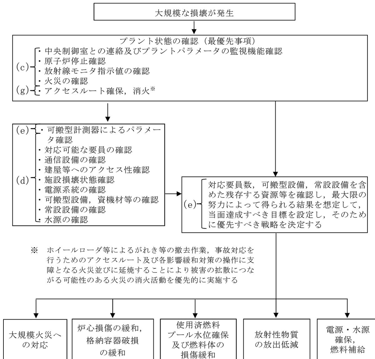
第2.1.3図 大規模損壊発生時の対応全体概略フロー
