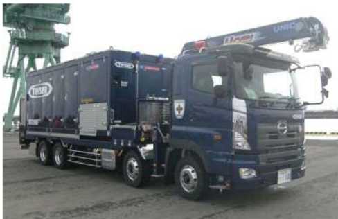
可搬型代替注水大型ポンプ
